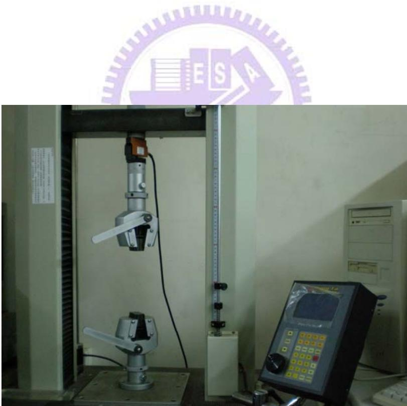
圖 4.4 電腦伺服控制材料試驗機
