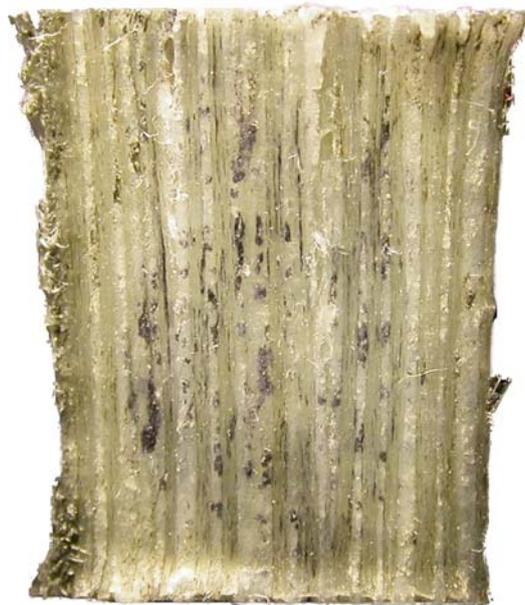
圖 3.24 添加二氧化矽含量 30%之 $0^\circ$ 之破壞試片
