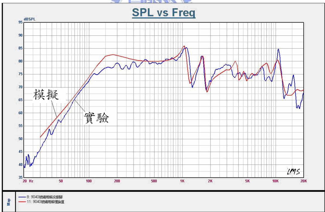
圖 3-8 中間具加勁 4mm 玻纖條揚聲器實驗與模擬聲壓曲線比較圖
