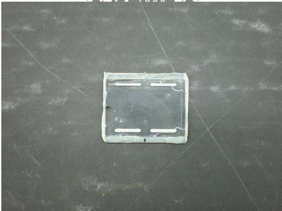
圖 3.4 EHC 液晶試片製作完成的照片
