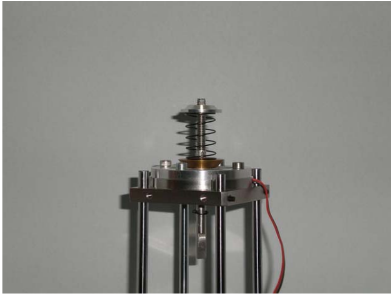
圖4.20 超音波馬達原型的實體照片
