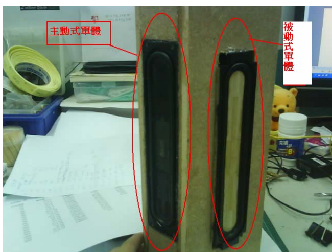
圖 5-22 被動輻射形音箱圖
