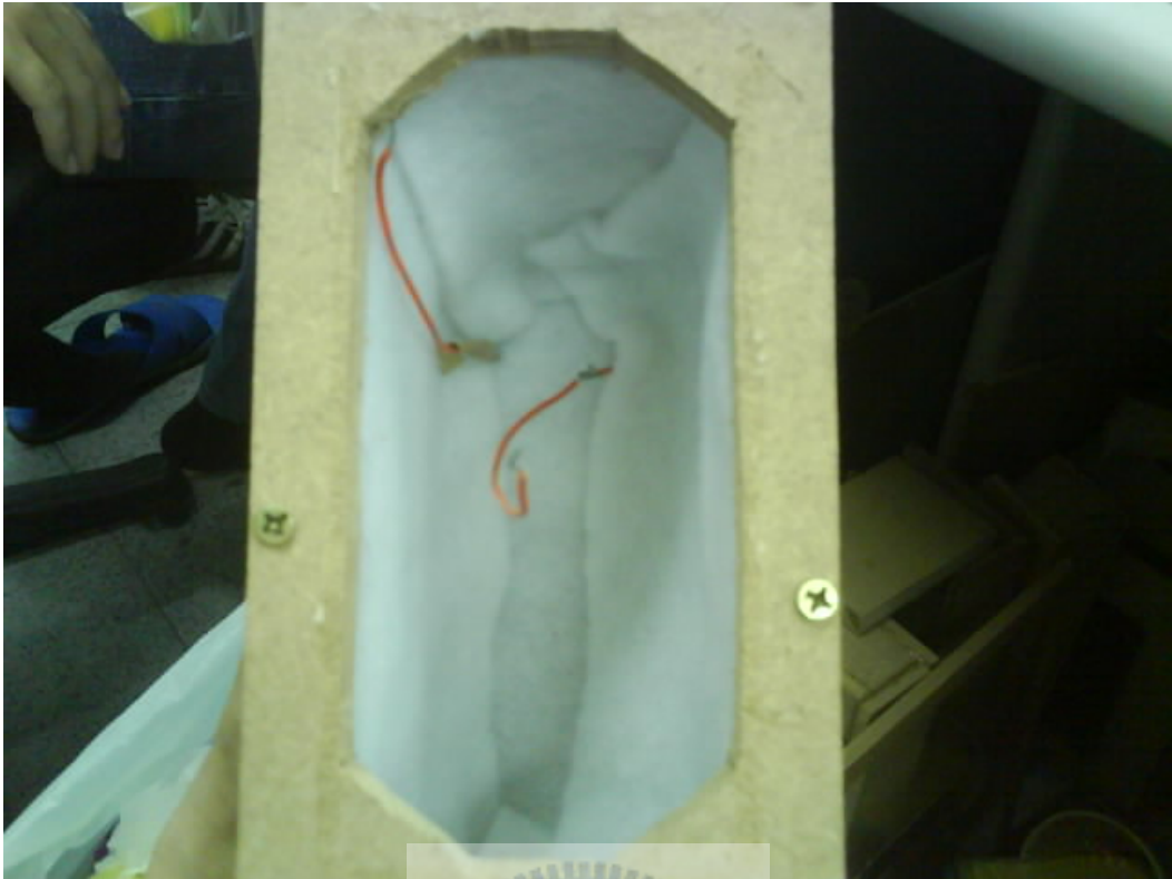
圖 5-3 吸音棉貼壁法
