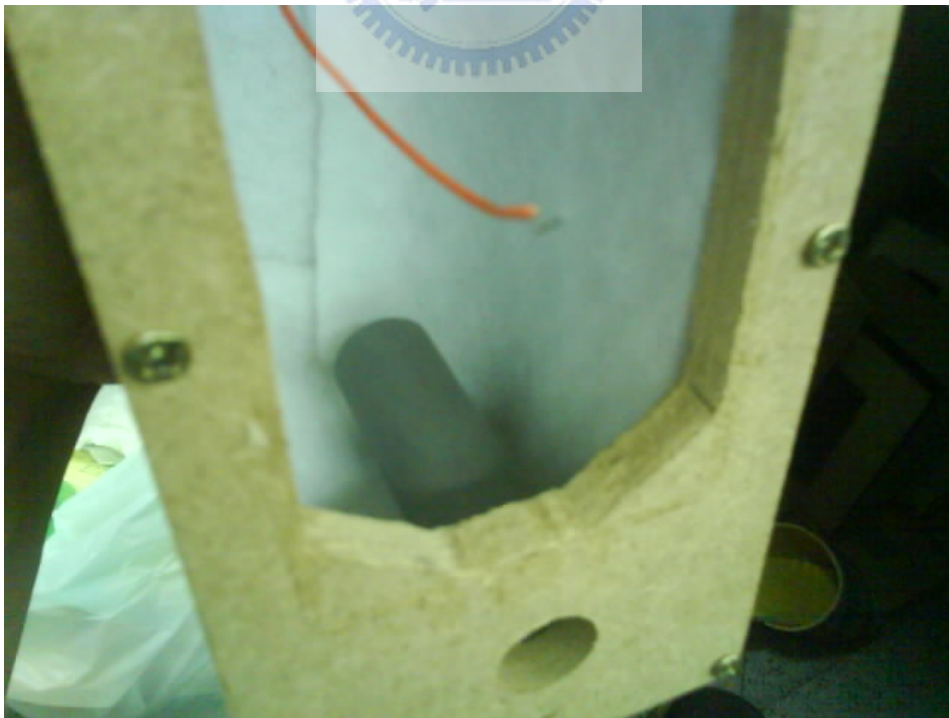
圖 5-12 低音管置放圖
