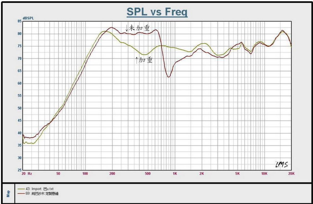
圖 6-32 系統三之二未加重與最佳化結果實驗聲壓曲線比較
