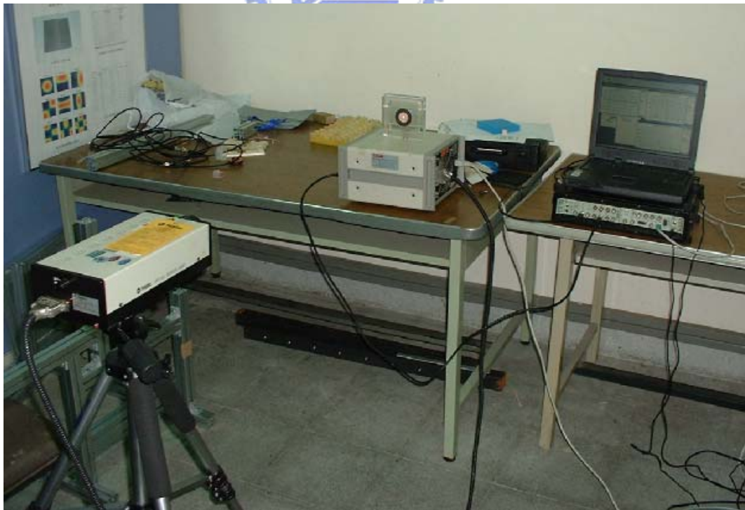
圖 5-12 阻尼比量測實驗架設示意圖
