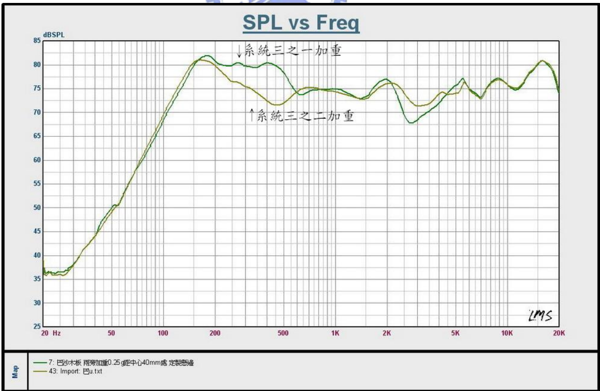
圖 6-33 系統三兩組最佳化結果實驗聲壓曲線比較
