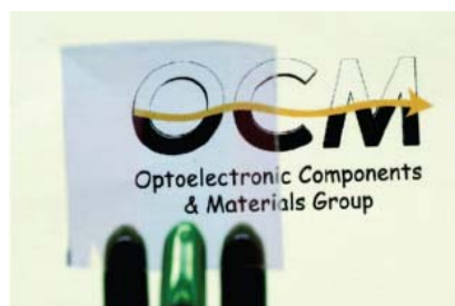
圖 1-17 玻璃上蒸鍍一層薄薄的銀，在其上再濺鍍一層ITO薄膜 [31]
