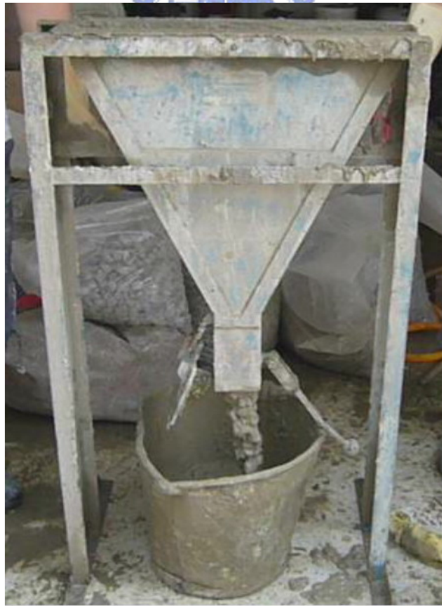
圖 2-4 V 型漏斗流出試驗情況
