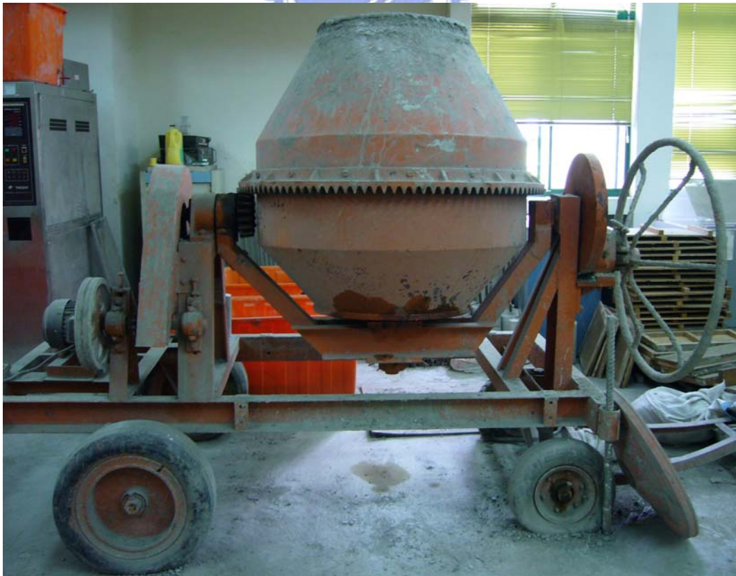
圖 4-7 大型重力式拌和機
