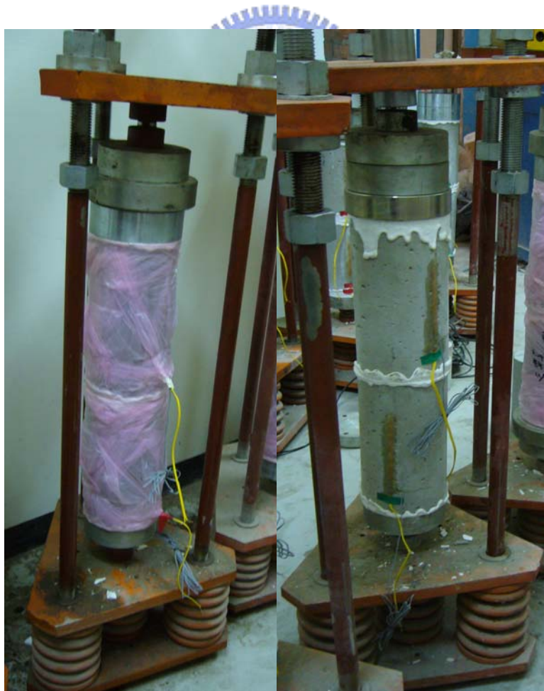
圖 4-26 含鋼筋混凝土潛變試體架設
