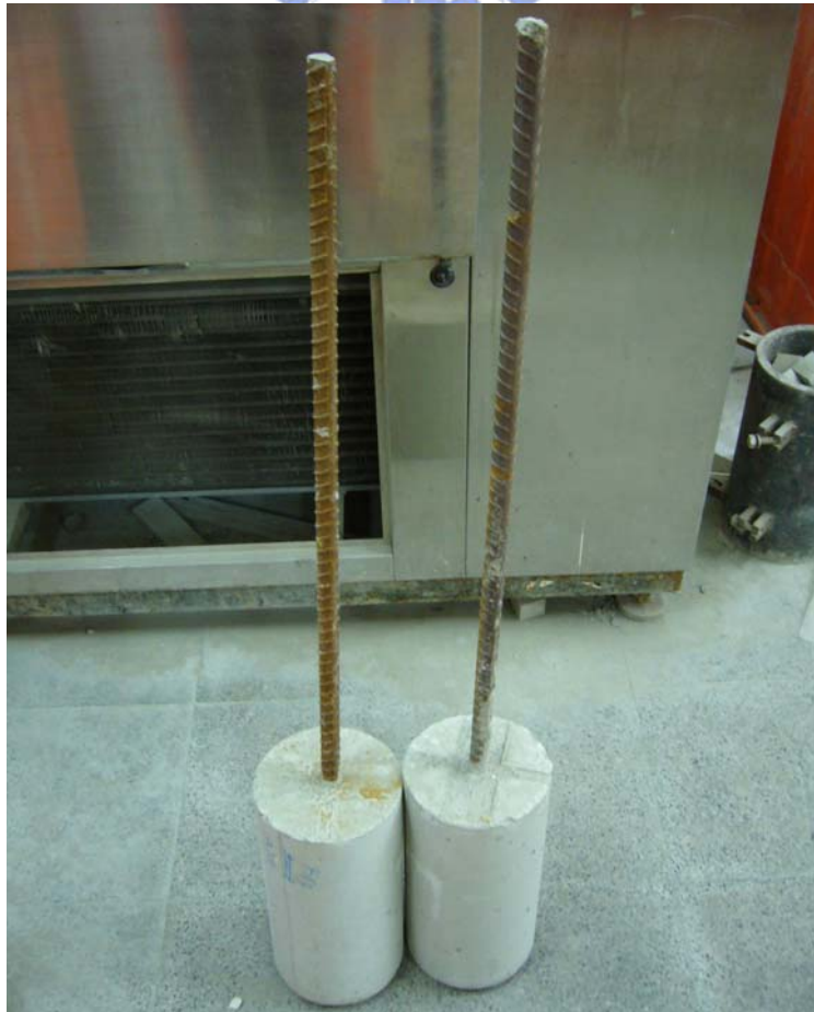
圖 4-5 混凝土握裹力試驗試體
