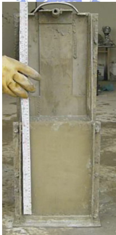
圖 2-6 障礙通過性試驗情況
