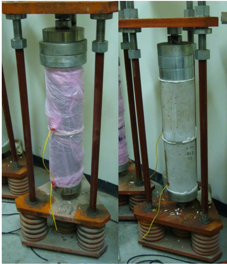
圖 4-23 純混凝土潛變試體架設
