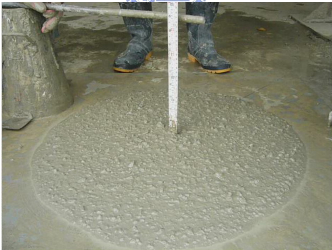
圖 2-2 坍流度試驗情況
