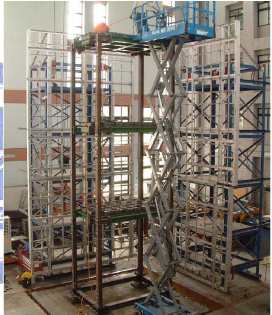
圖 4.13 三層樓鋼構架(Benchmark A)之照片 (NCREE 提供)
