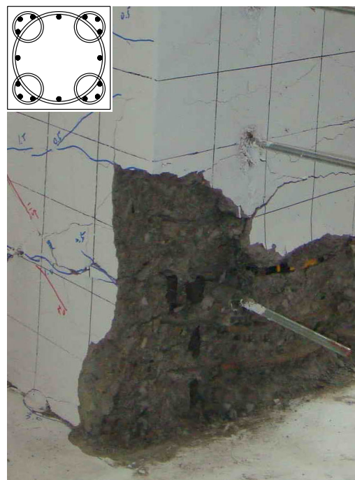
(b) 五螺箍圍束區域內之混凝土、主 筋與箍筋仍然保持良好狀態
