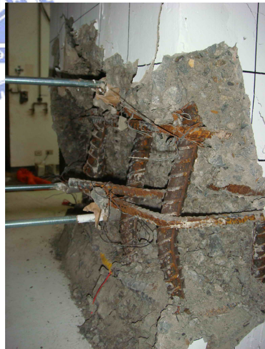
(d) 柱底主筋挫屈及橫箍彎鉤脫出
