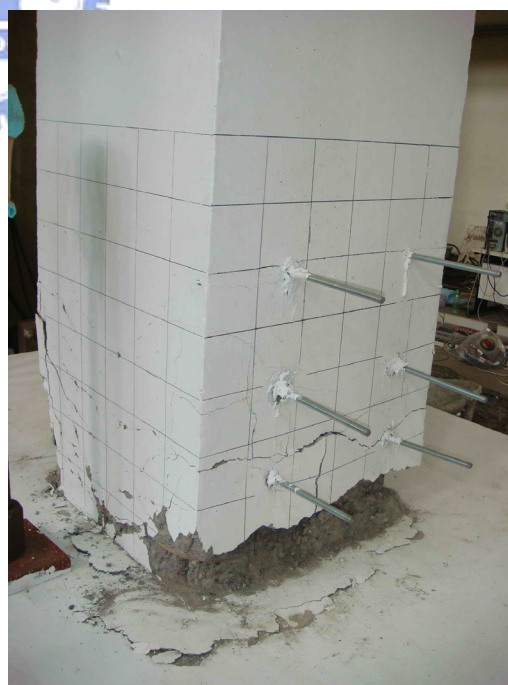
(d) 五螺箍圍束區域內之混凝土、主 筋與箍筋仍然保持良好狀態
