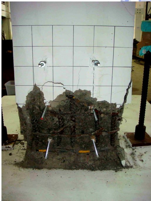
(c) 柱底塑鉸區混凝土剝落情形
