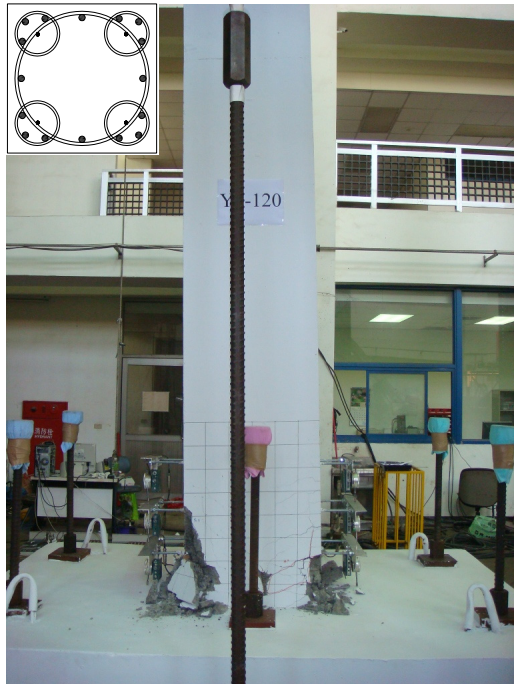
(a) Drift Angle 達 5.2% radians 第一迴圈 (b) Drift Angle 達 5.2% radians 第三迴圈
