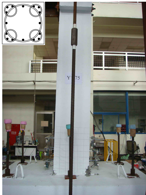
(a) Drift Angle 達 4.0% radians 第一迴圈 (b) Drift Angle 達 4.0% radians 第三迴圈
