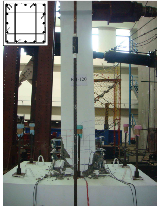
(a) Drift Angle 達 5.2% radians 第一迴圈 (b) Drift Angle 達 5.2% radians 第三迴圈
