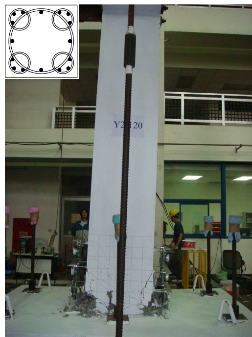
(a) Drift Angle 達 5.4% radians 第一迴圈 (b) Drift Angle 達 5.4% radians 第三迴圈
