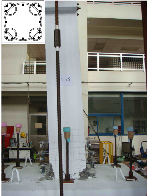
(a) Drift Angle 達 5.7% radians 第一迴圈 (b) Drift Angle 達 5.7% radians 第三迴圈
