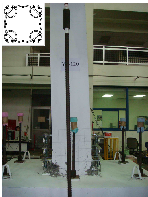
(a) Drift Angle 達 5.4% radians 第一迴圈 (b) Drift Angle 達 5.4% radians 第三迴圈
