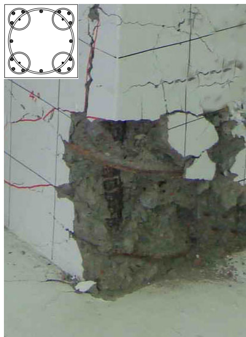
(b) 柱底主筋挫屈變形
