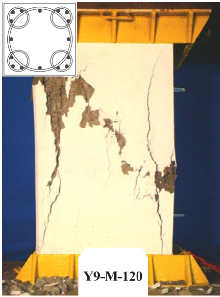
(a) 試體 Y9-M-120 達極限載重 P_u 時之破壞情形(極限載重 P_u = 17771 \text{ kN} )
