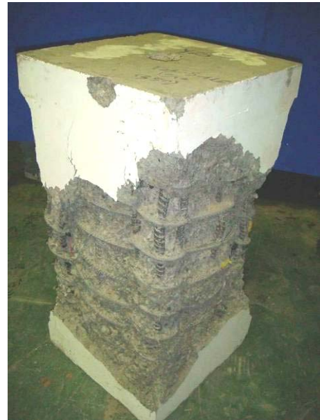
(b) 試體 Y15-S-115 在試驗終止後剝除破裂混凝土之破壞情形
