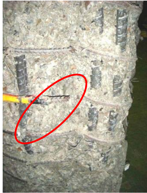
照片 4.4 試體 YW1-S-110 大螺箍連續斷裂
