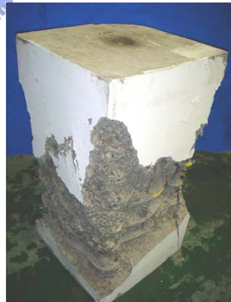
(b) 試體 Y14-S-145 在試驗終止後剝除破裂混凝土之破壞情形
