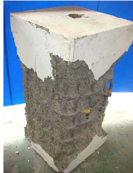
(b) 試體 Y11-L-140 在試驗終止後剝除破裂混凝土之破壞情形
