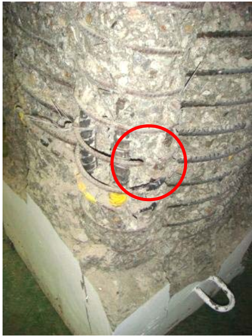
照片 4.3 試體 YW2-S-55 小螺箍局部斷裂
