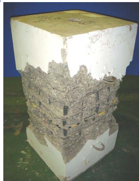
(b) 試體 YW3-M-55 在試驗終止後剝除破裂混凝土之破壞情形
