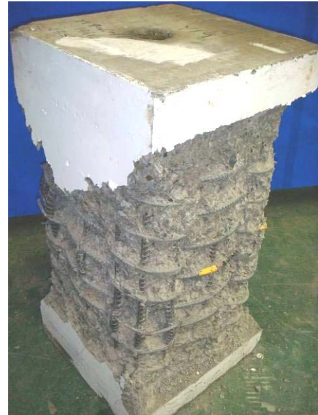
(b) 試體 Y13-L-110 在試驗終止後剝除破裂混凝土之破壞情形
