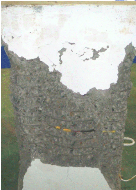
(a) 試驗終止且剝除破裂混凝土後之情形
