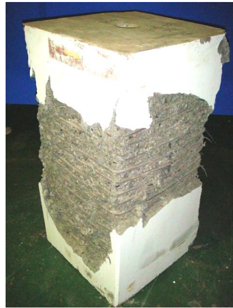
(b) 試體 RW2-50 在試驗終止後剝除破裂混凝土之破壞情形
