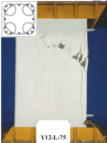
(a) 試體 Y12-L-75 達極限載重 P_u 時之破壞情形(極限載重 P_u = 19405 \text{ kN} )
