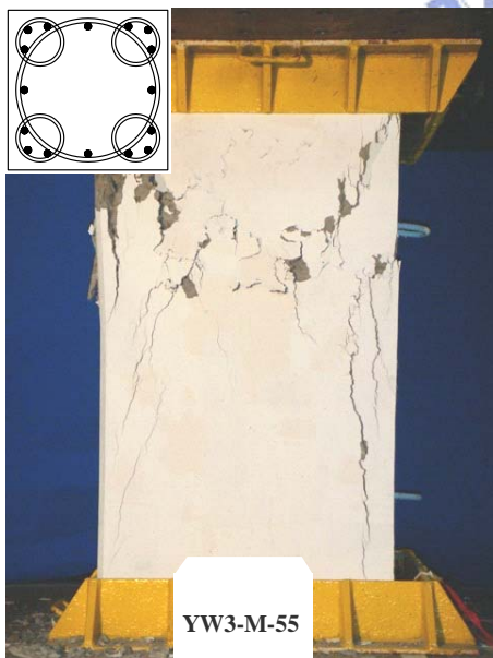
(a) 試體 YW3-M-55 達極限載重 P_u 時之破壞情形(極限載重 P_u=18907\text{ kN} )
