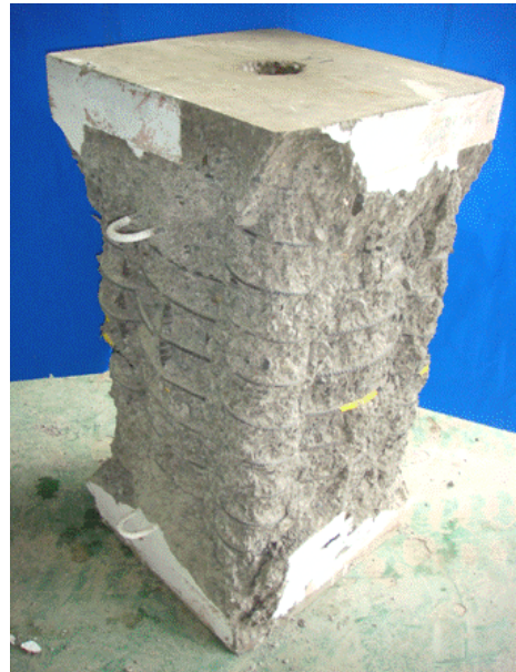
(b) 試體 Y1-S-95 在試驗終止後剝除破裂混凝土之破壞情形
