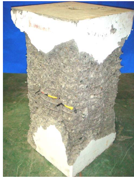
(b) 試體 YW4-M-SPE 在試驗終止後剝除破裂混凝土之破壞情形
