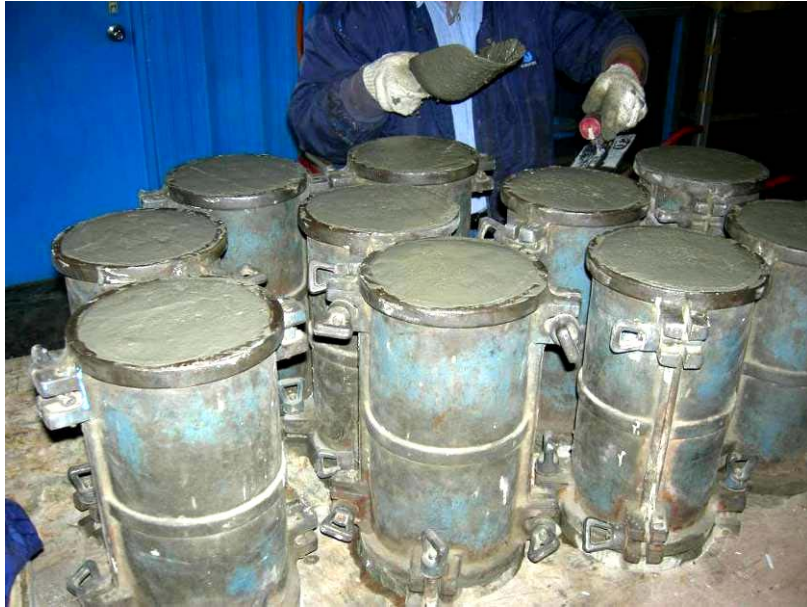
照片 3.2 在短柱試體灌漿時同時製作 150 \times 300 \text{ mm} 之標準混凝土圓柱試體
