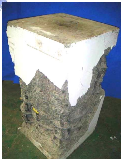
(b) 試體 Y2-S-145 在試驗終止後剝除破裂混凝土之破壞情形
