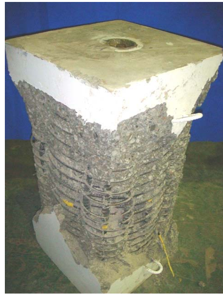
(b) 試體 YW8-L-50 在試驗終止後剝除破裂混凝土之破壞情形
