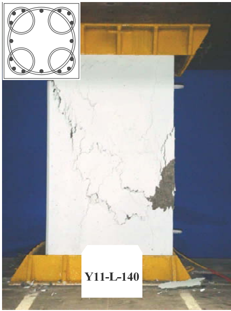
(a) 試體 Y11-L-140 達極限載重 P_u 時之破壞情形(極限載重 P_u = 15659 \text{ kN} )
