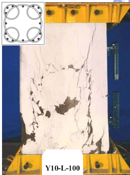
(a) 試體 Y10-L-100 達極限載重 P_u 時之破壞情形(極限載重 P_u = 15227 \text{ kN} )
