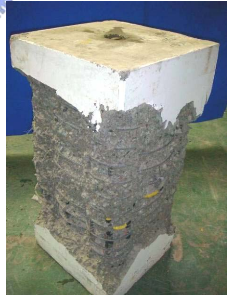
(b) 試體 Y12-L-75 在試驗終止後剝除破裂混凝土之破壞情形
