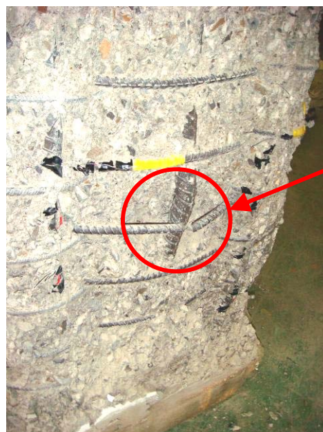
照片 3.7 大螺箍斷裂之破壞模式 (試體 Y10-L-100, 箍筋間距為 100 mm, 大、小螺箍線徑分別為 D13 與 D10)
