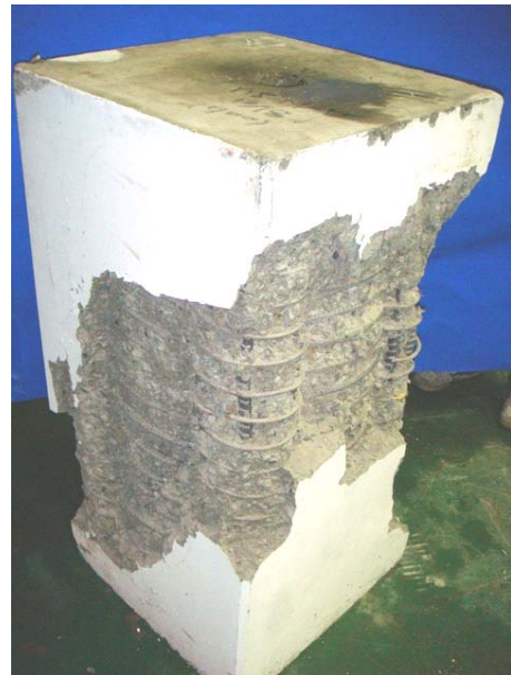
(b) 試體 YW6-M-55 在試驗終止後剝除破裂混凝土之破壞情形
