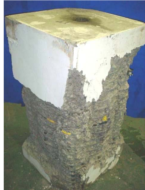
(b) 試體 Y5-M-55 在試驗終止後剝除破裂混凝土之破壞情形
