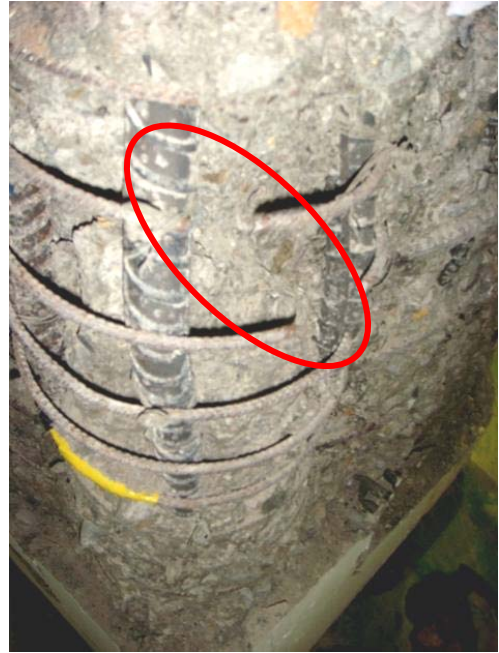
(b) 角落之小螺箍連續性斷裂
