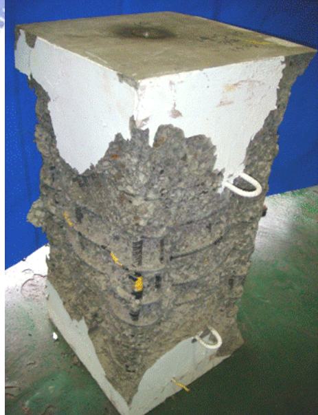
(b) 試體 Y4-S-115 在試驗終止後剝除破裂混凝土之破壞情形
