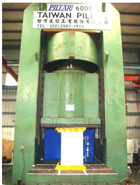
照片 3.6 短柱試體架設於 58800 kN 抗壓試驗機平台上之情形照片
