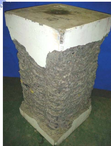
(b) 試體 Y8-M-75 在試驗終止後剝除破裂混凝土之破壞情形
