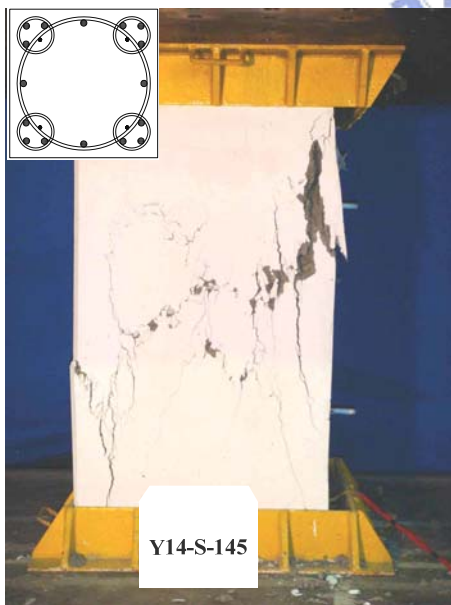
(a) 試體 Y14-S-145 達極限載重 P_u 時之破壞情形(極限載重 P_u = 13728 \text{ kN} )
