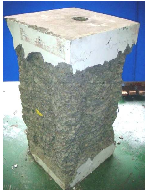
(b) 試體 Y3-S-75 在試驗終止後剝除破裂混凝土之破壞情形
