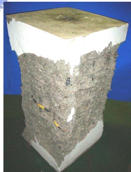
(b) 試體 YW9-S-110 在試驗終止後剝除破裂混凝土之破壞情形
