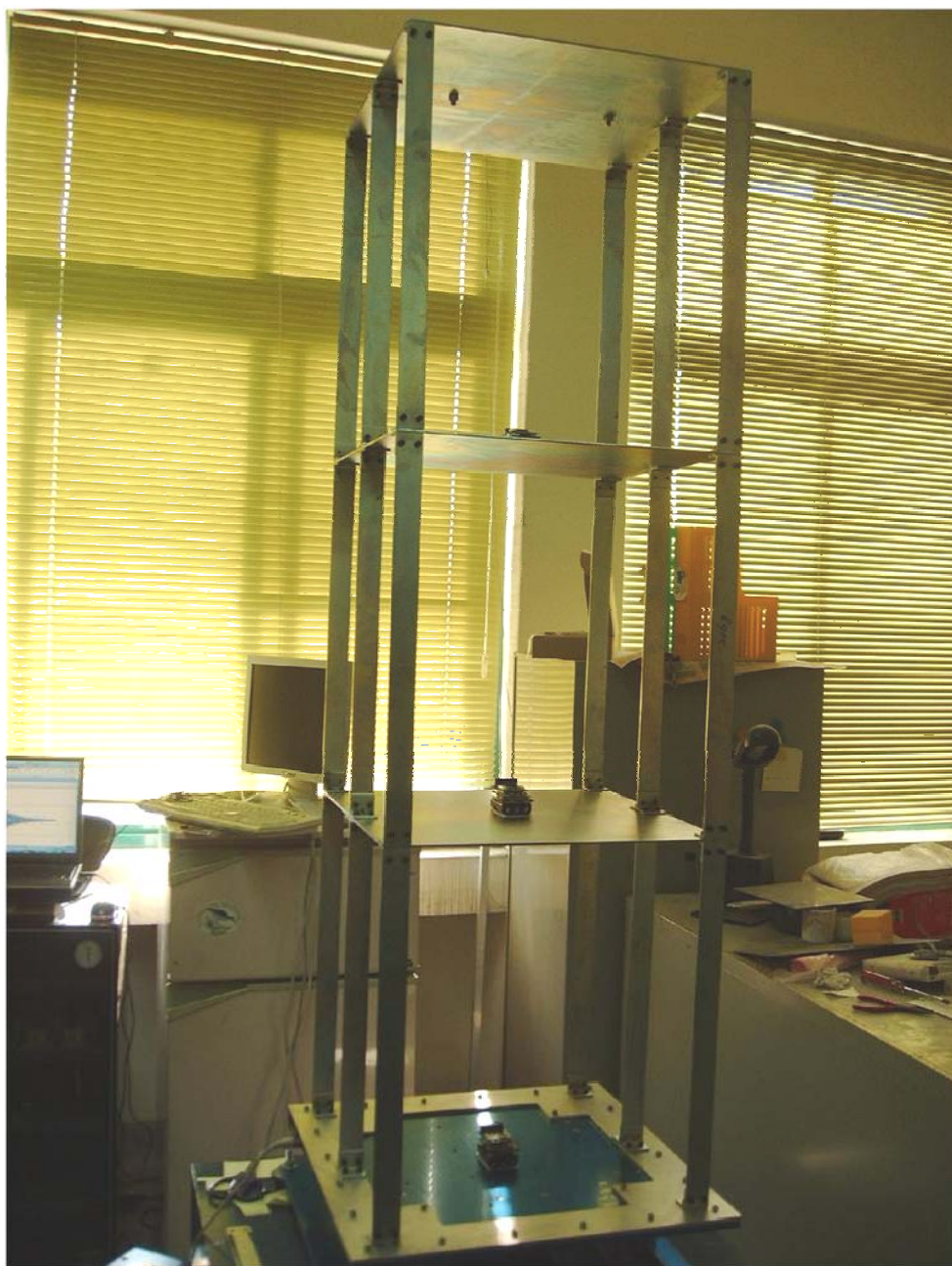
圖 3.9 實體構架實際照片圖與無線感應器擺設方式
