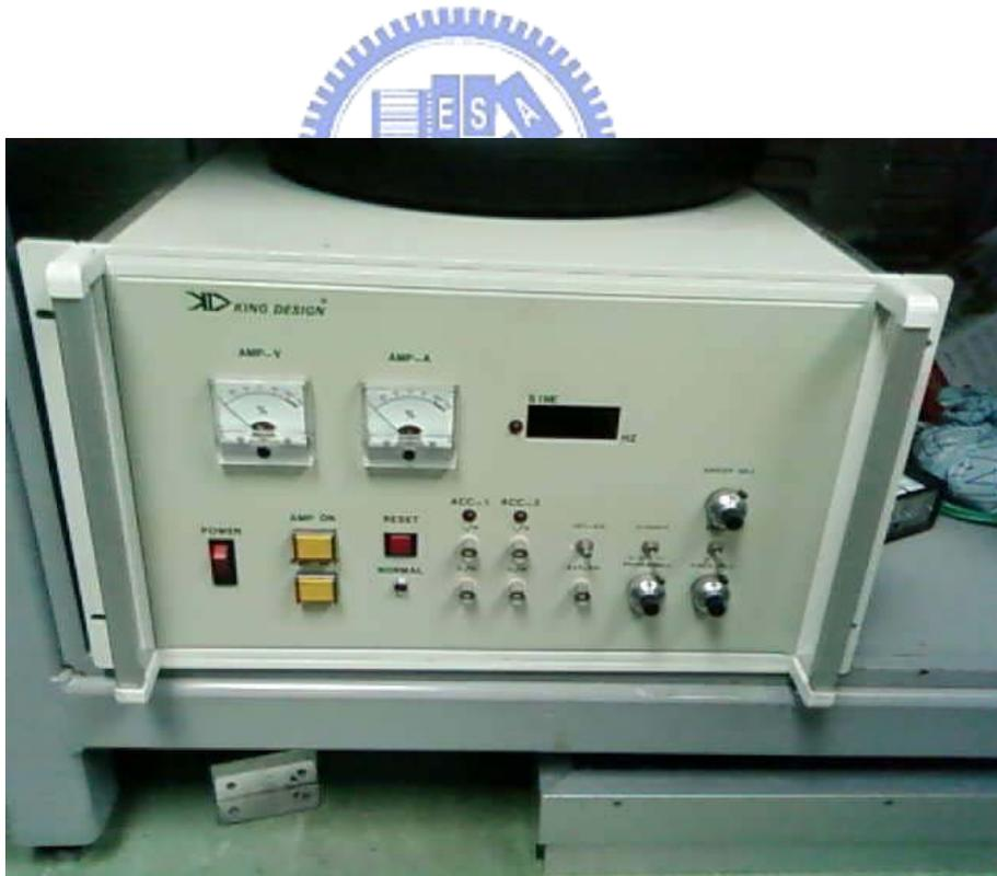
圖 3-13 振動台訊號主機
