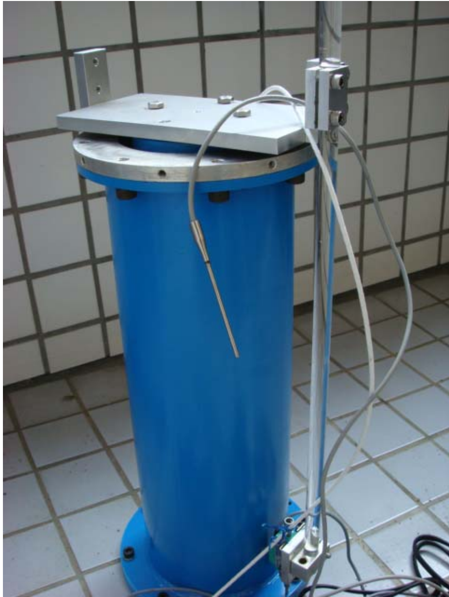
圖 3-15 溫度位移感測器裝上裝置
