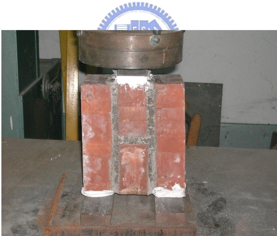
圖【3-17】黏結磚之剪力強度試驗
