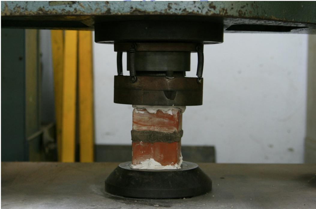
圖【3-15】黏結磚之抗壓強度試驗
