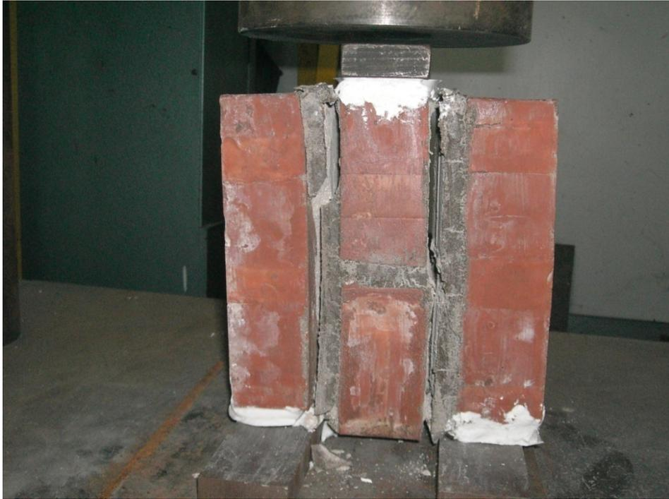
圖【4-20】黏結磚剪力試驗破壞情形
