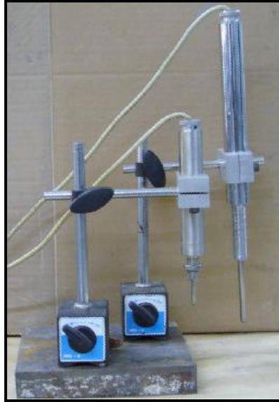
圖【3-10】線性差動變壓器 (LVDT)
