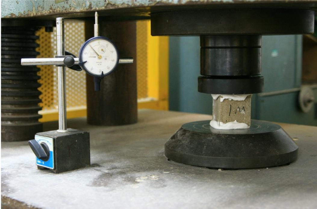
圖【3-14】抗壓強度試驗
