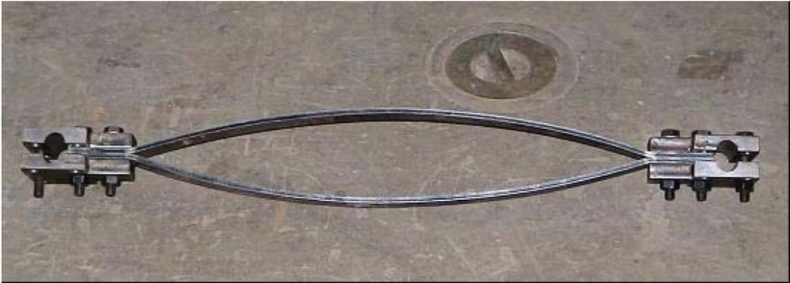
圖 1.9 挫屈連桿 (buckled struts) 元件【11】
