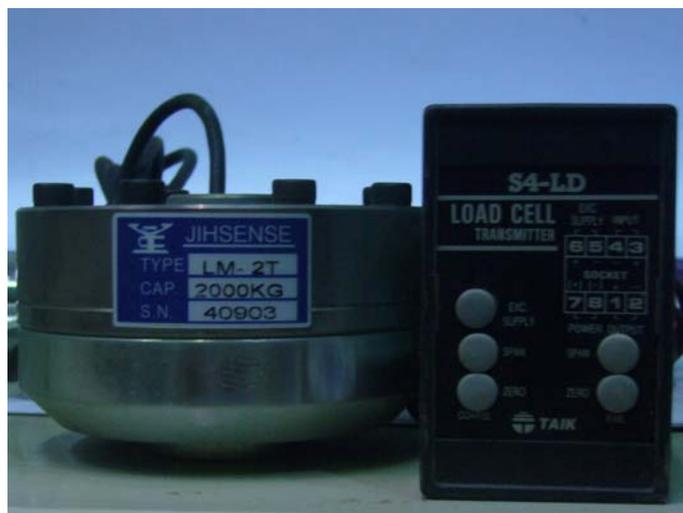
圖 5.8 力規(Loadcell)
