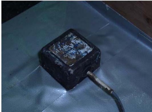
圖 5.6 加速規(Accelerometers)
