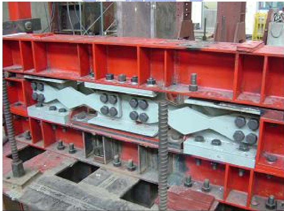
圖 4.26 對稱配置挫屈連桿元件測試之試驗構架
