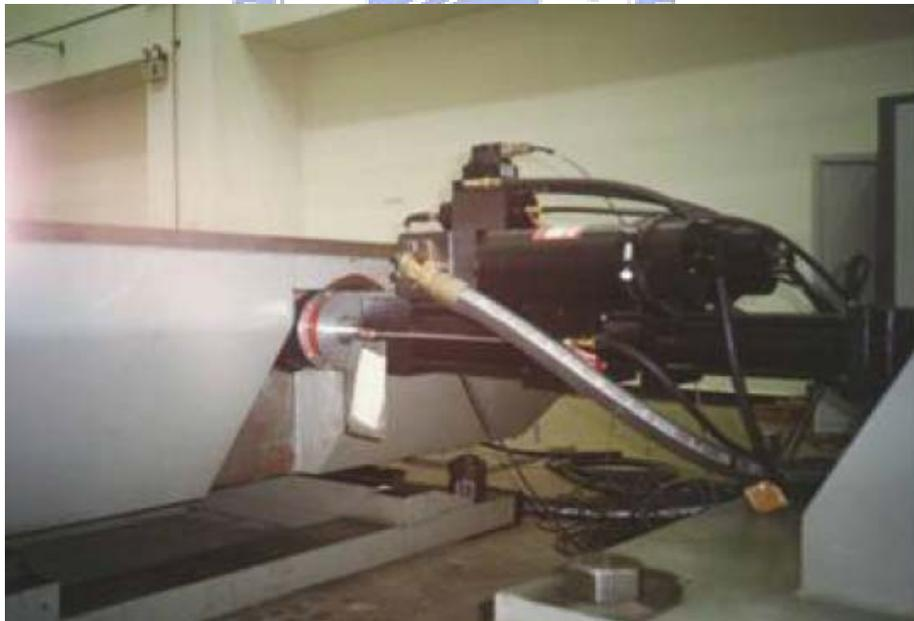
圖 5.3 驅動振動台之油壓致動器
