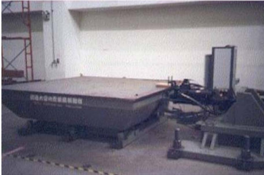
圖 5.2 地震模擬振動台
