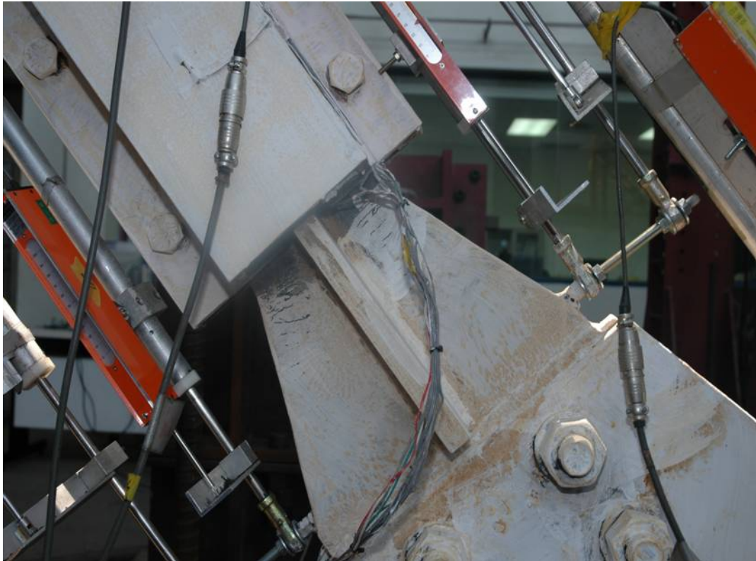
照片 3.21 量測試體兩端殘餘變形量示意圖
