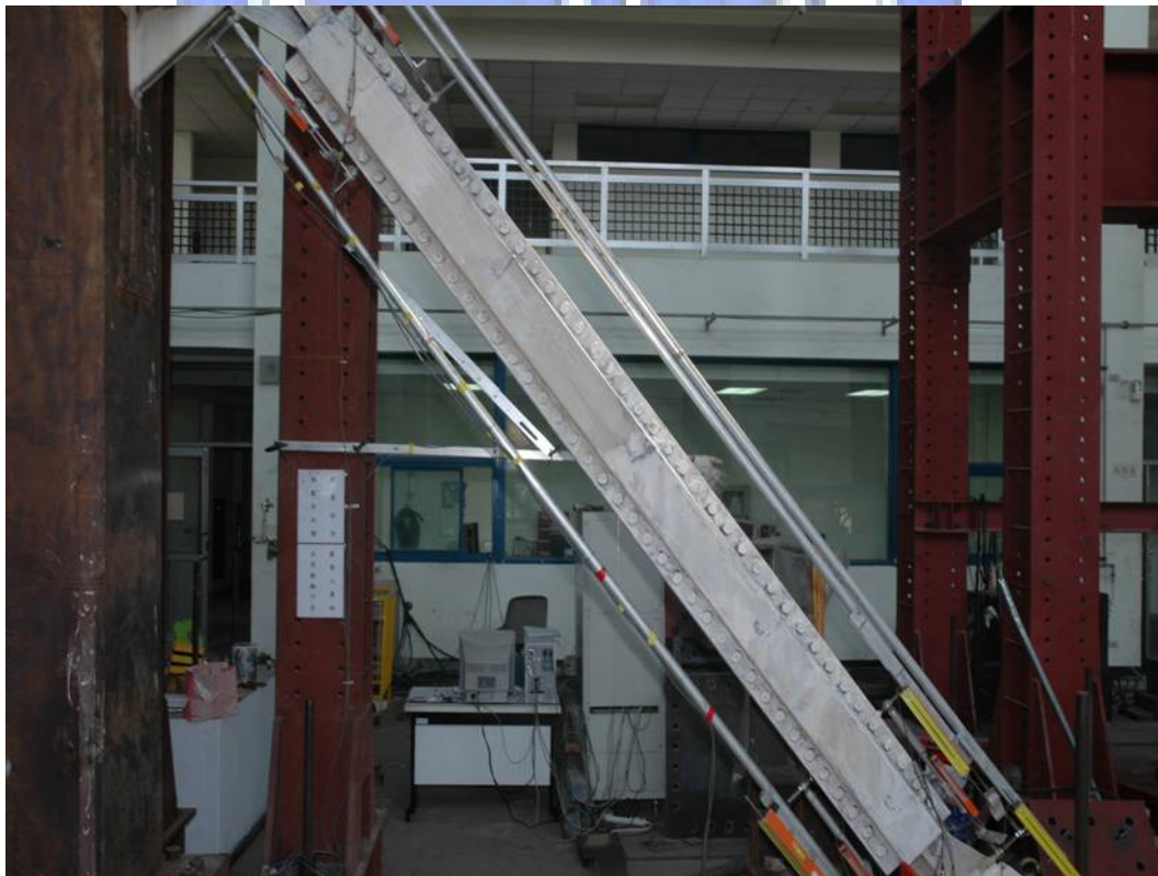
照片 3.32 試體 3 螺栓 80 顆(第一次試驗)
