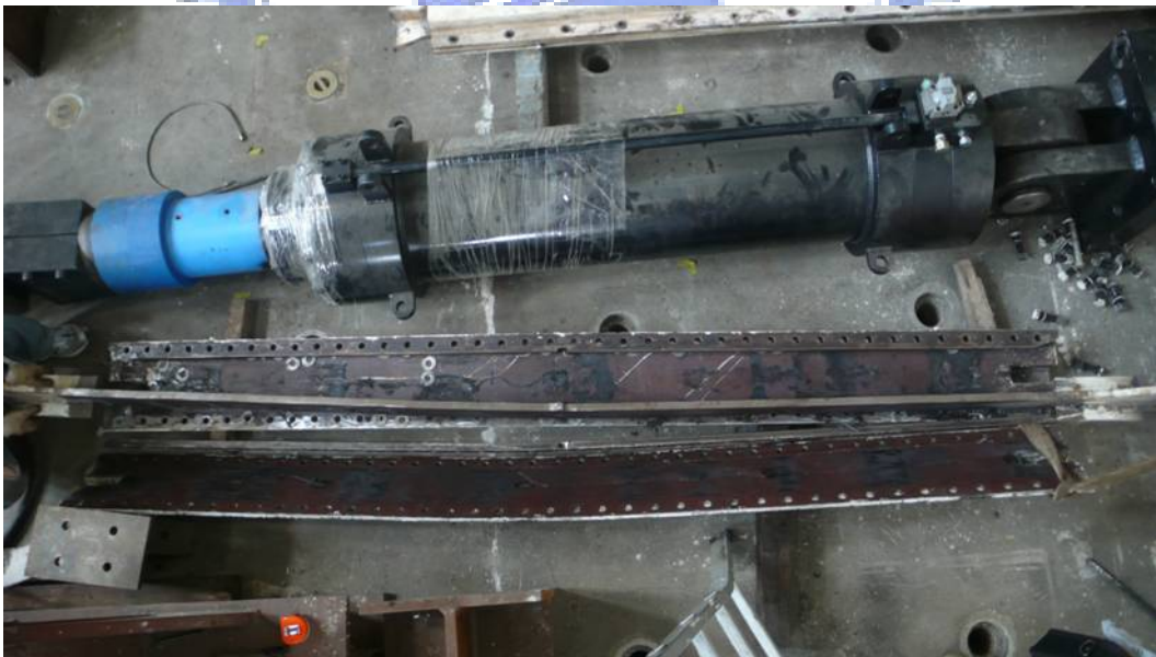
照片 3.46 試體 3 核心單元產生第一挫屈模態
