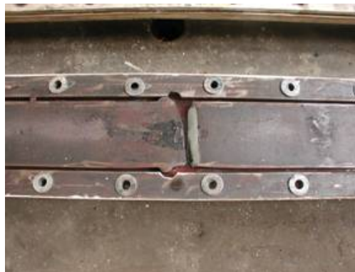
照片 3.24 試體 1 核心單元斷裂
