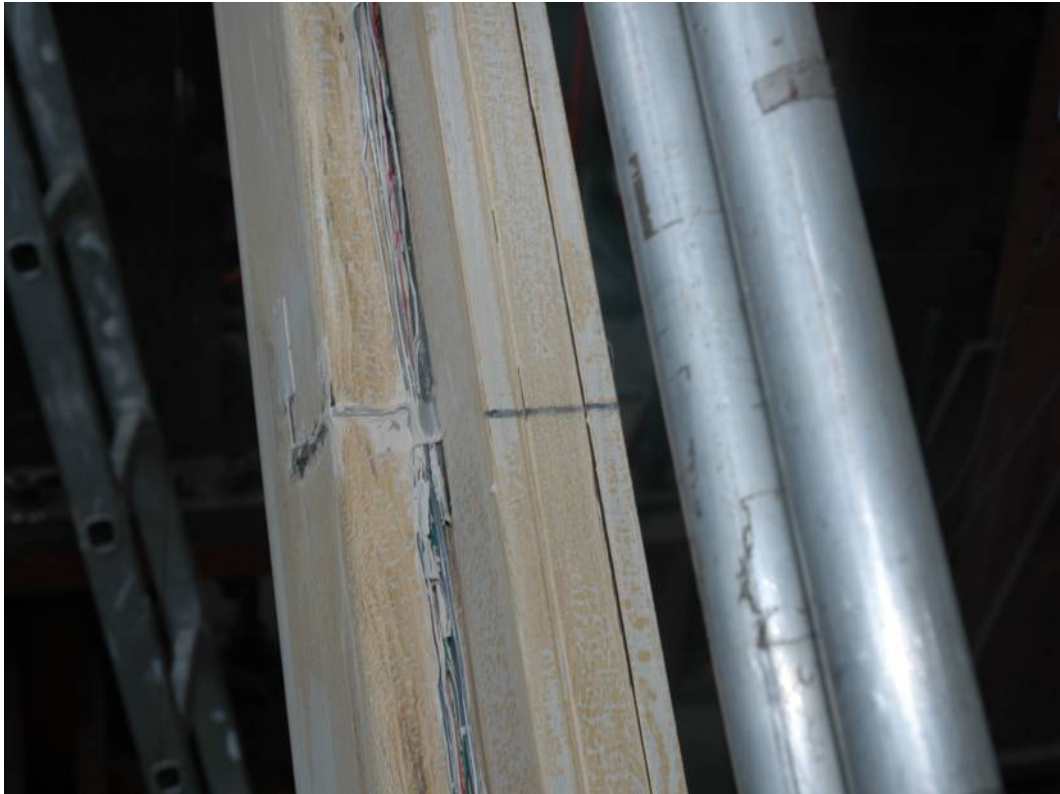
照片 3.53 試體 4 核心單元與面板間並未產生相對滑動( \alpha=0.018 rad)
