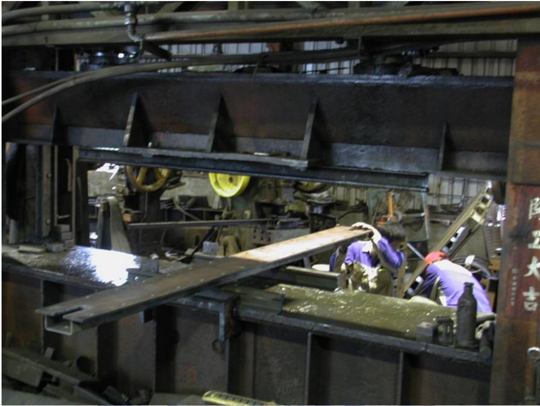
照片 3.3 置入整平機整平
