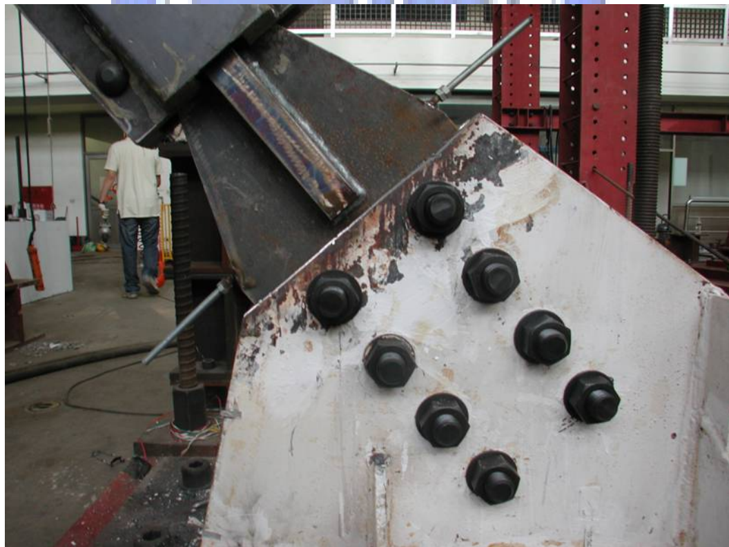
照片 3.18 接合段與接合板採用螺栓接合
