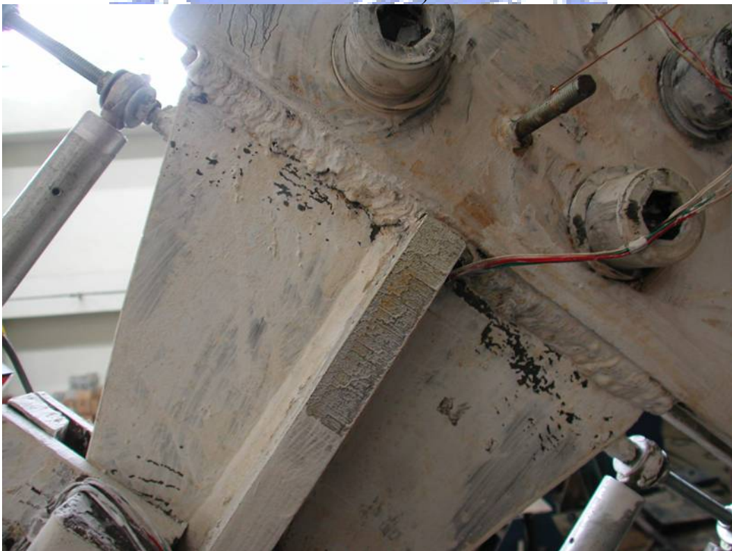
照片 3.43 試體 3 轉換段與接合板焊道補強處產生裂縫(第三次試驗， \alpha=0.03 rad)
