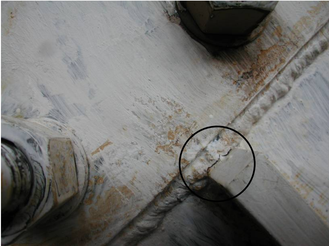
照片 3.43 試體 3 轉換段與接合板焊道補強處產生裂縫(第三次試驗， \alpha=0.03 rad)
