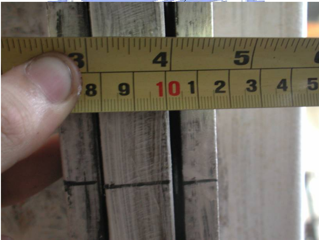
照片 3.41 試體 3 螺栓與螺栓周圍之面板出現降伏現象(第三次試驗， \alpha=0.03 rad)
