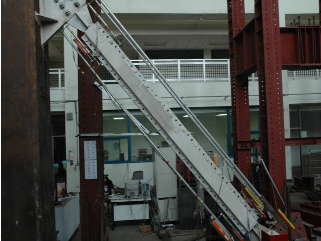
照片 3.34 試體 3 螺栓 28 顆(第二次試驗)
