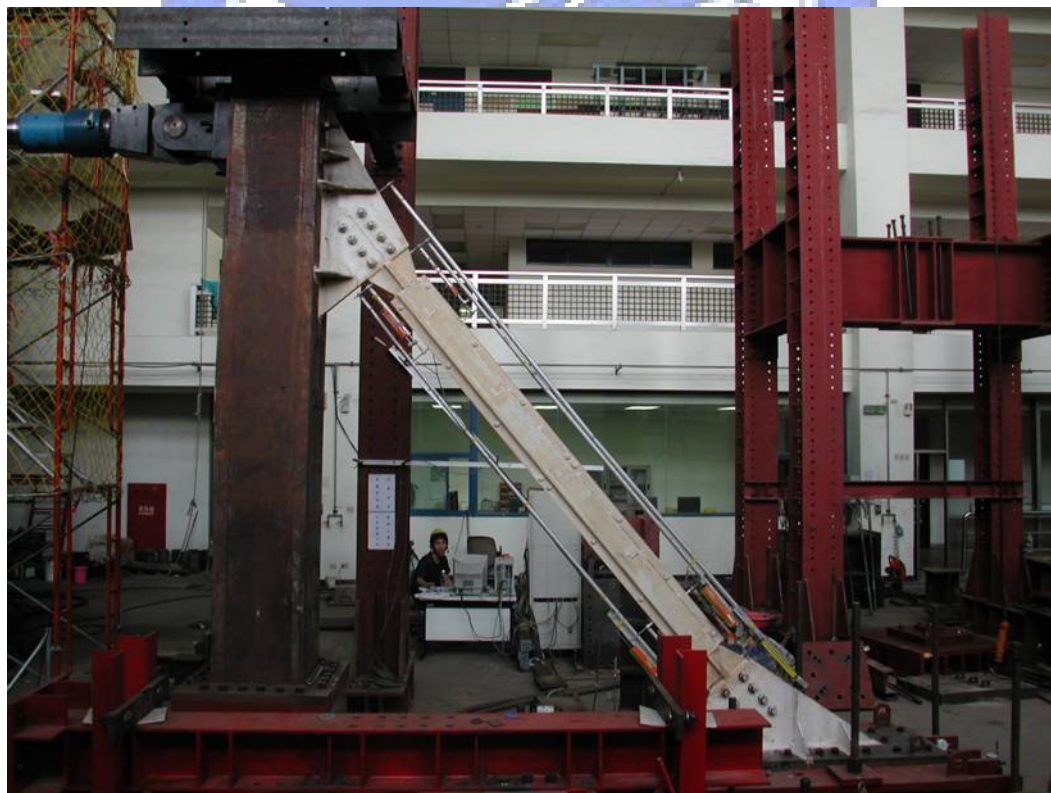
照片 3.50 試體 4 發生整體挫屈現象(正視, \alpha=0.018 rad)
