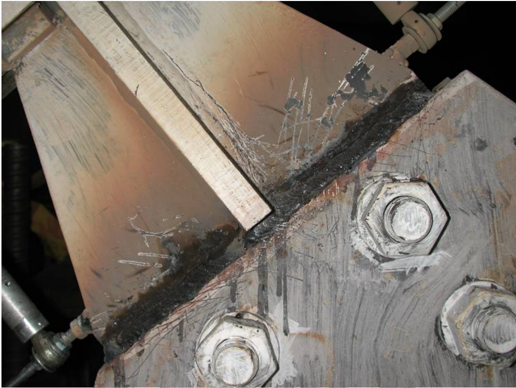
照片 3.19 焊道補強情形
