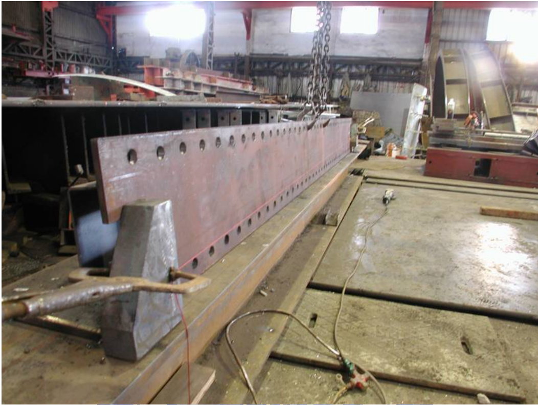
照片 3.11 圍束構件中點與端部相對位置量測方式
