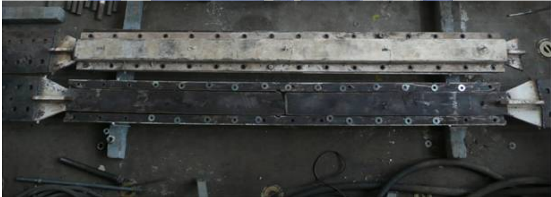
照片 3.23 試體 1 下端殘餘變形( \alpha=0.024 rad)
