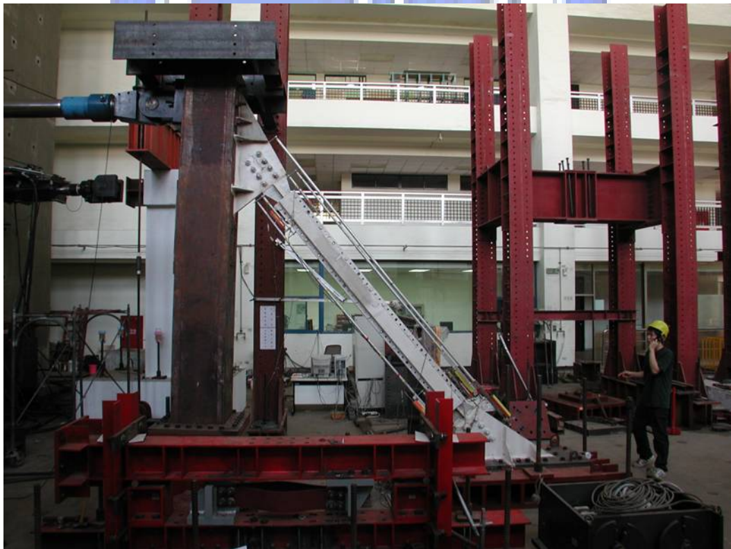
照片 3.36 試體 3 發生整體挫屈現象(正視，第三次試驗， \alpha=0.03 rad)
