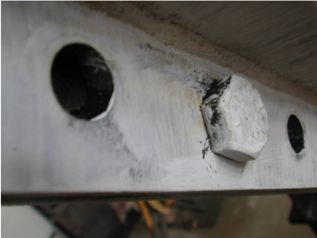
照片 3.41 試體 3 螺栓與螺栓周圍之面板出現降伏現象(第三次試驗， \alpha=0.03 rad)
