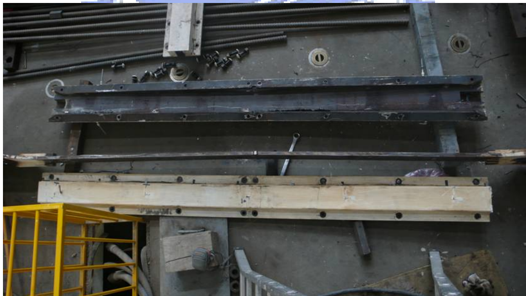
照片 3.56 試體 4 核心單元產生第一挫屈模態
