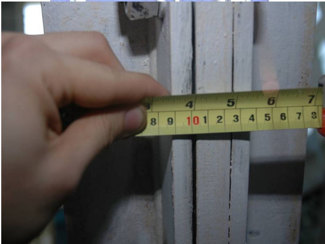
照片 3.22 量測核心單元與面板間之淨距示意圖
