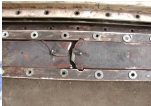
照片 3.29 試體 2 核心單元斷裂
