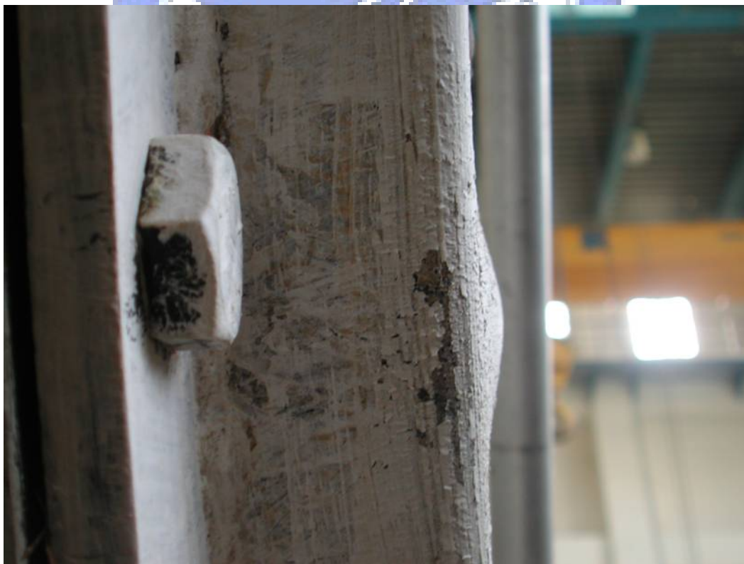
照片 3.40 試體 3 圍束單元產生面外變形(第三次試驗, \alpha=0.03 rad)
