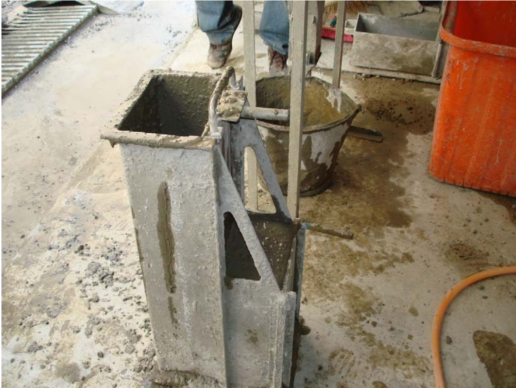
照片 3.5 自充填混凝土U型試驗
