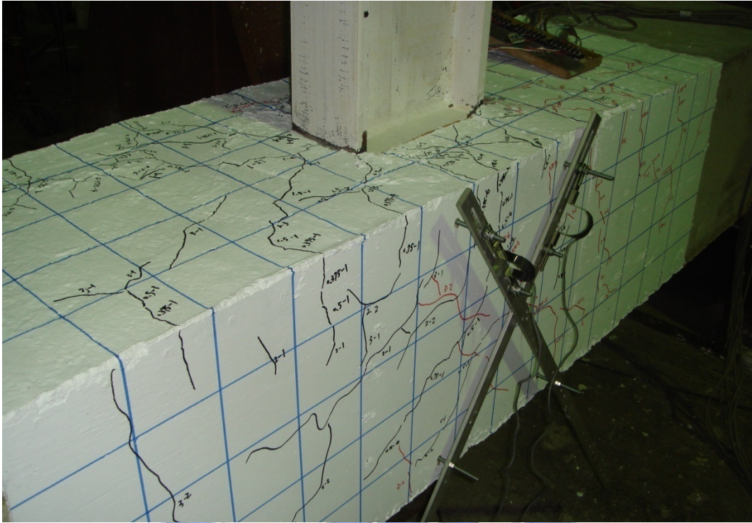
照片 4.29 試體SR0.6-R6 裂縫發展情形 (3% drift)
