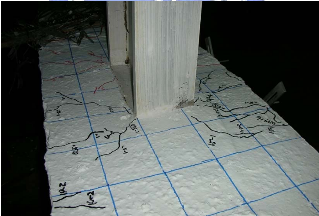
照片 4.8 試體SR0.6-R8 裂縫情況 (2% drift)
