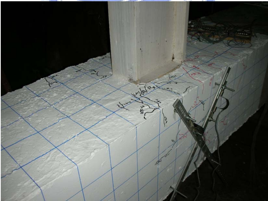
照片 4.6 試體SR0.6-R8 裂縫發展情形 (1% drift)
