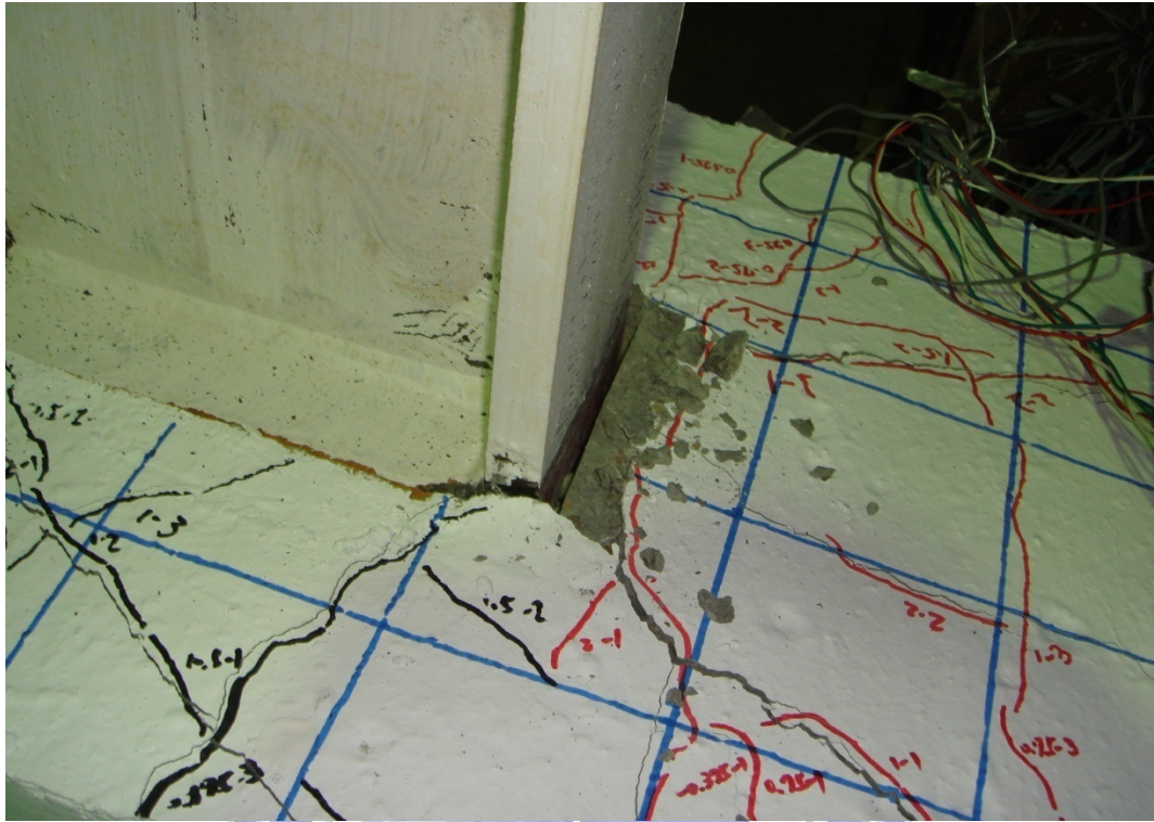
照片 4.31 試體SR0.6-R6 鋼梁翼板周圍混凝土被擠壓約 4 mm 間隙 (5% drift)
