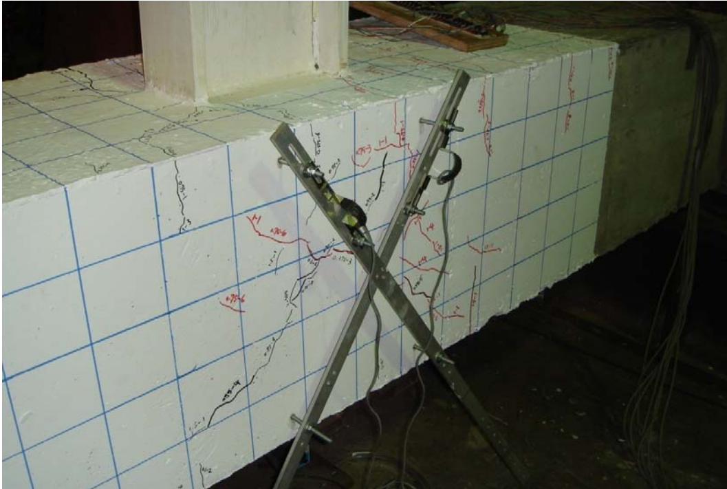
照片 4.13 試體SR0.4-R8 交會區裂縫發展情形 (1.5% drift)
