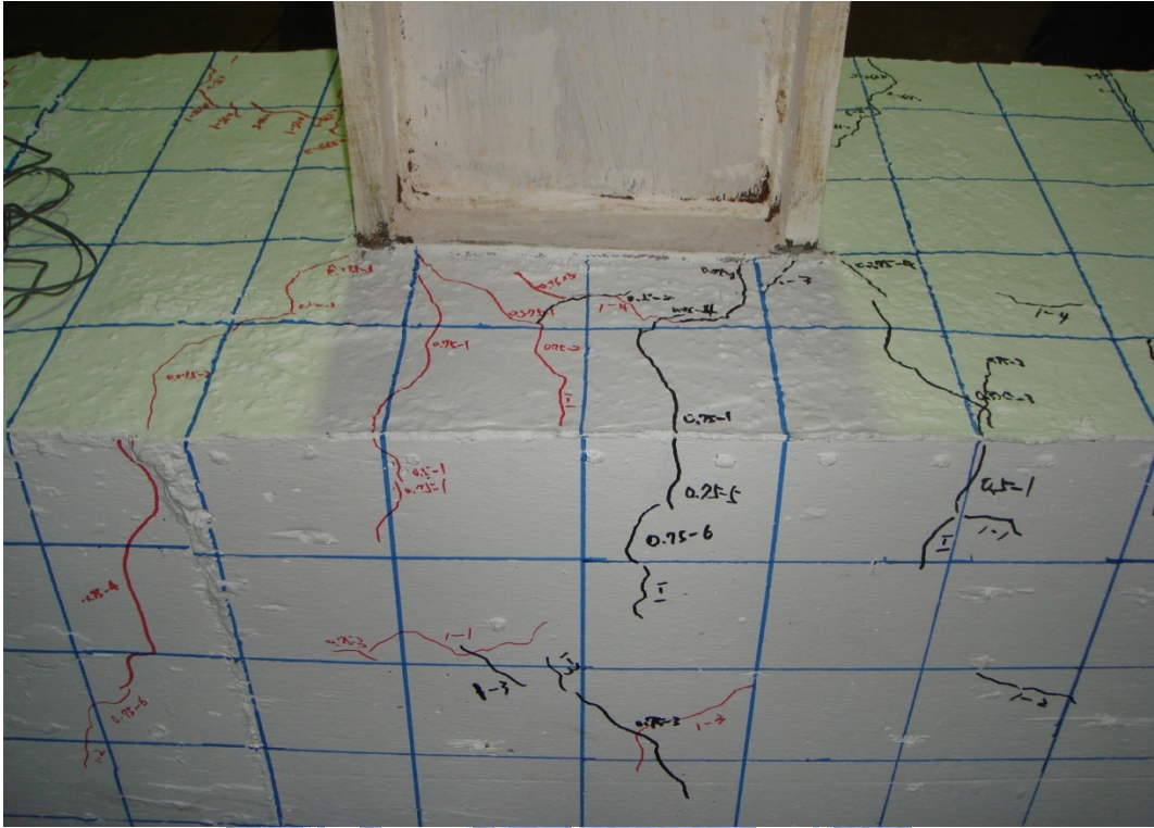
照片 4.19 試體SR0.8-R6 裂縫發展情形 (1% drift)
