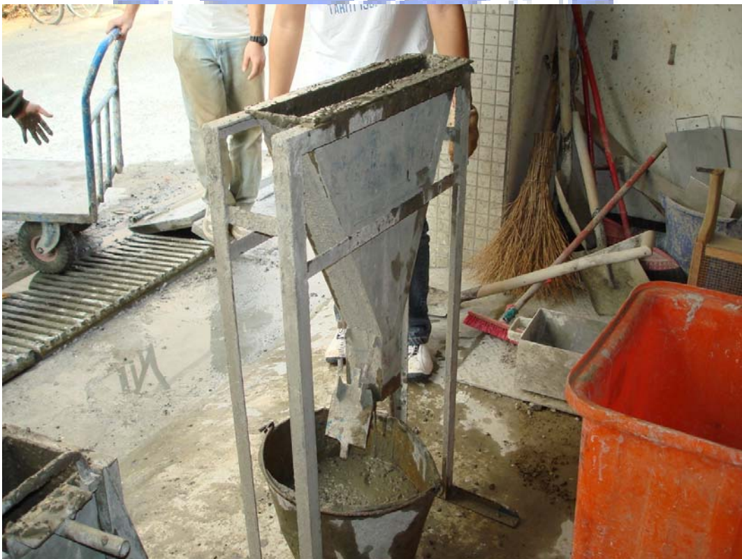
照片 3.4 自充填混凝土V型漏斗流出時間試驗 (7~20 秒)
