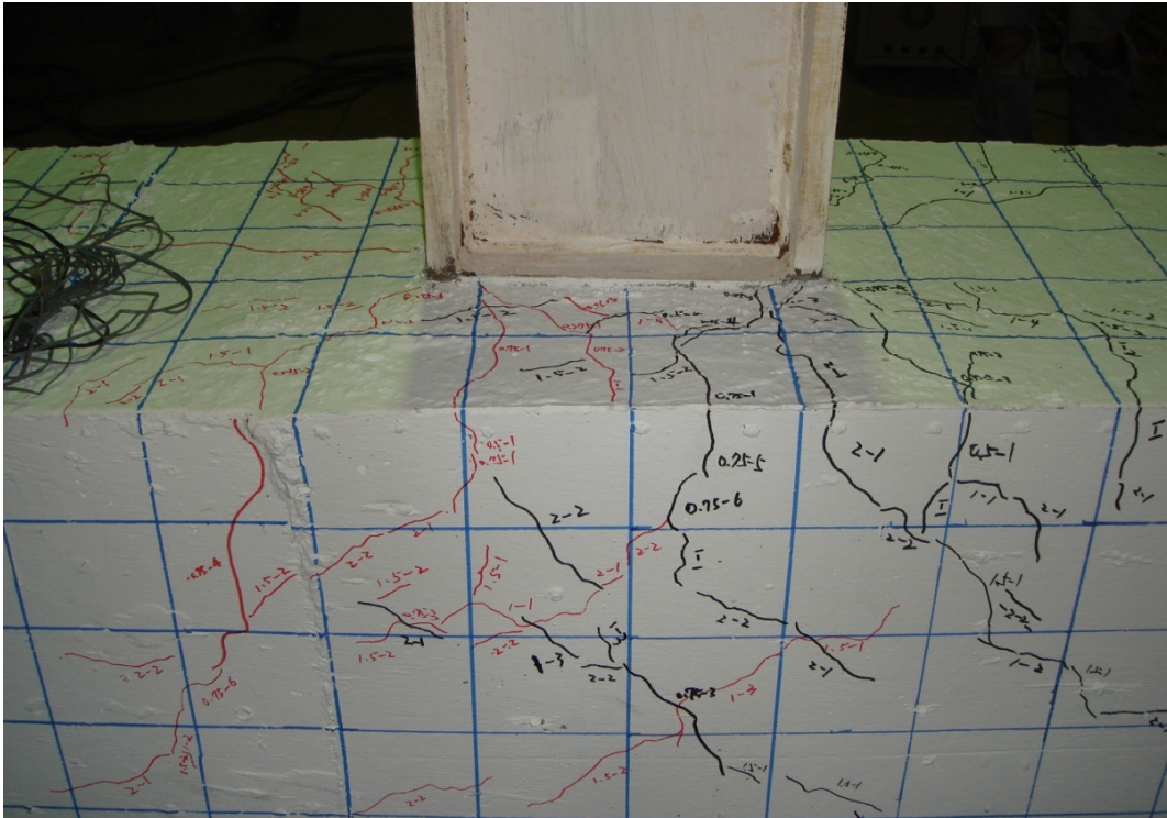
照片 4.21 試體SR0.8-R6 裂縫發展情形 (2% drift)
