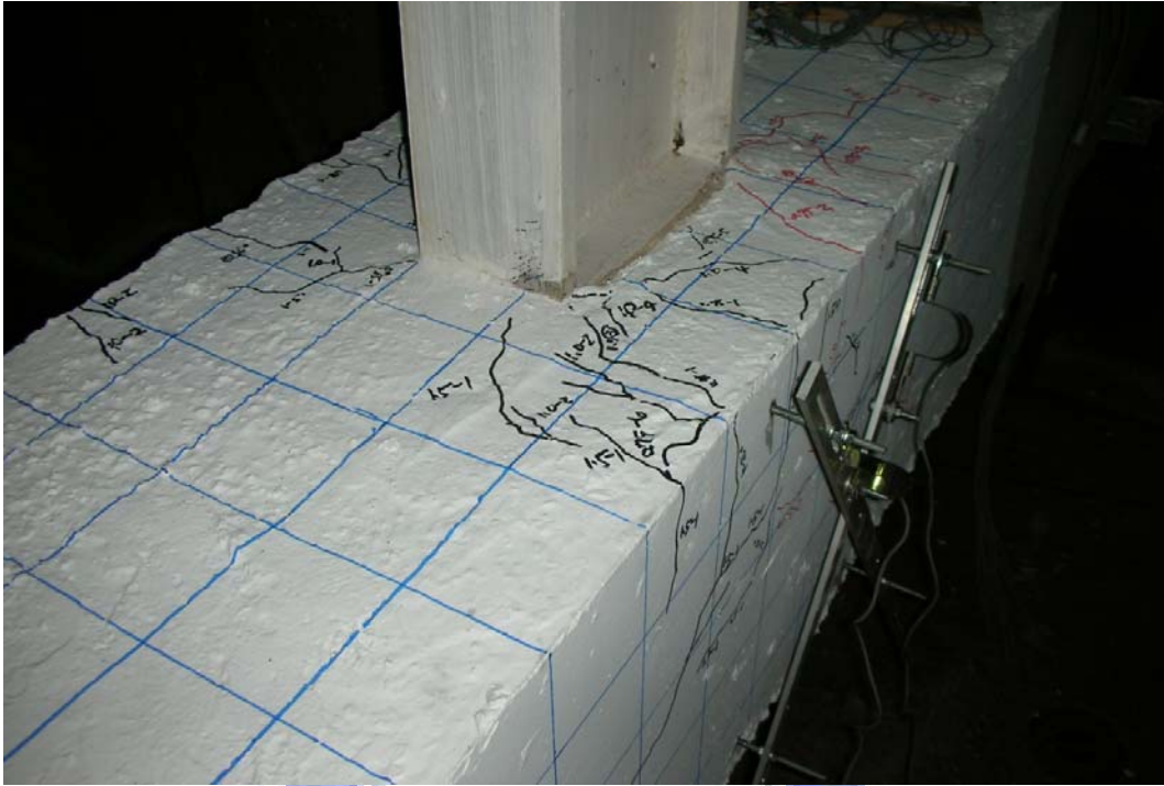
照片 4.7 試體SR0.6-R8 裂縫發展情形 (1.5% drift)
