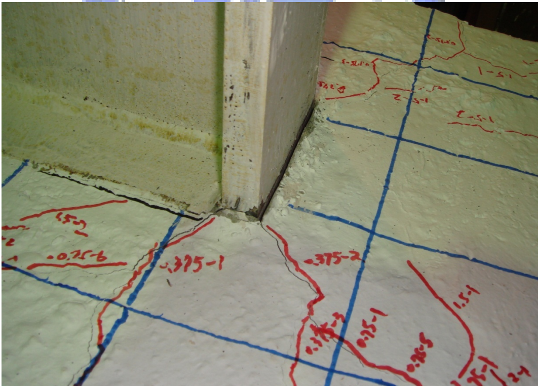
照片 4.20 試體SR0.8-R6 鋼梁翼板周圍混凝土被擠壓約 1 mm 間隙 (2% drift)
