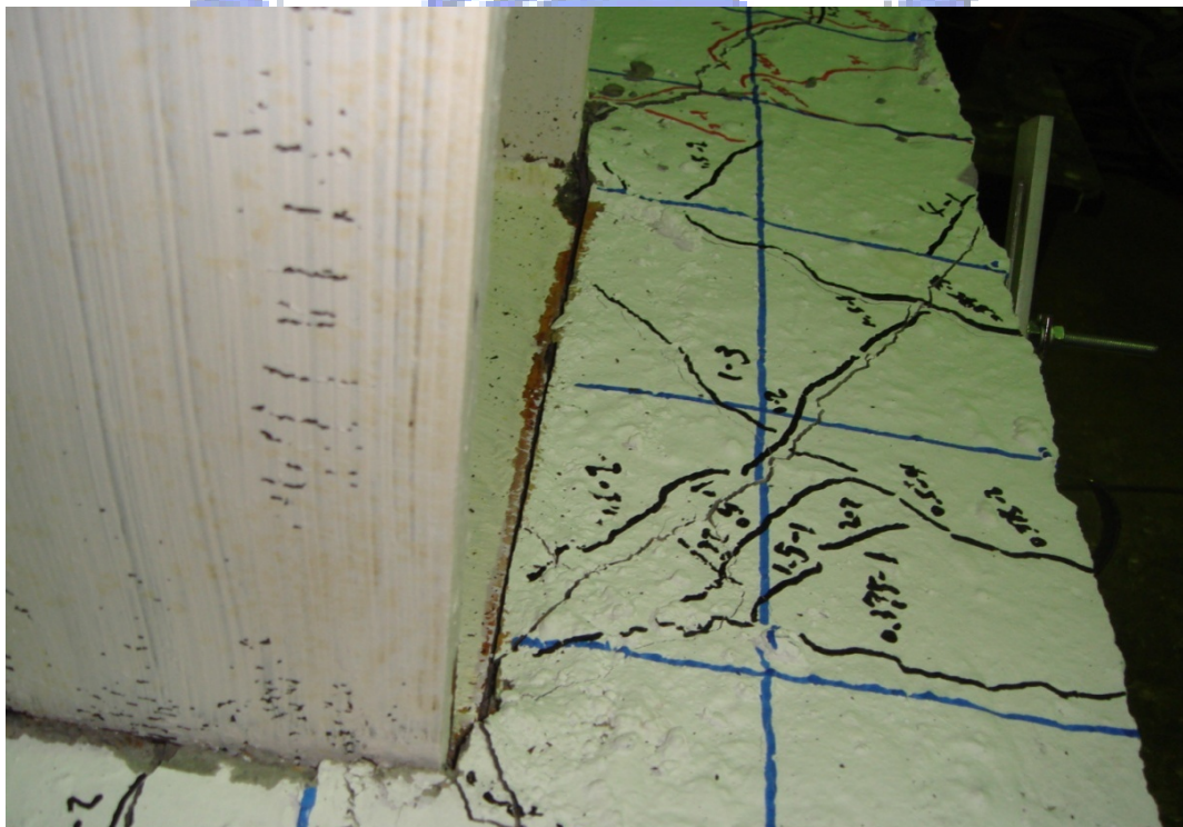
照片 4.32 試體SR0.6-R6 承壓面板被拉開 (4% drift)
