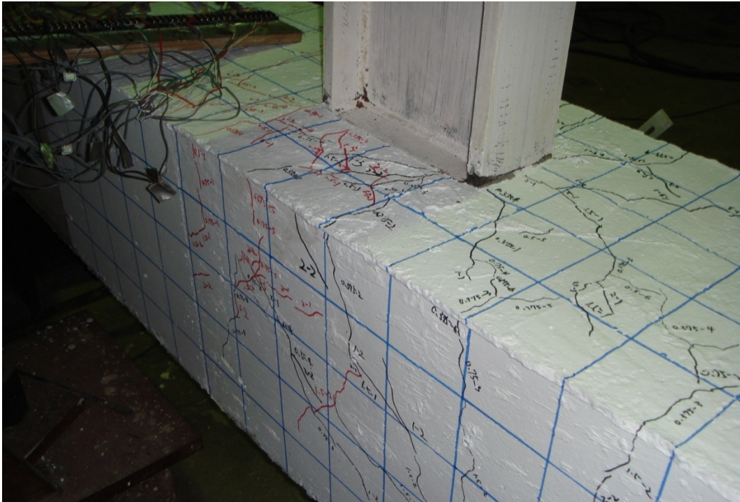
照片 4.27 試體SR0.6-R6 裂縫發展情形 (2% drift)
