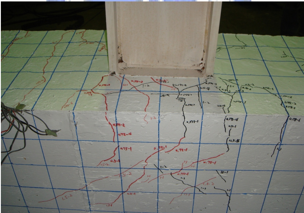
照片 4.34 試體SR0.4-R6 裂縫發展情形 (1.5% drift)
