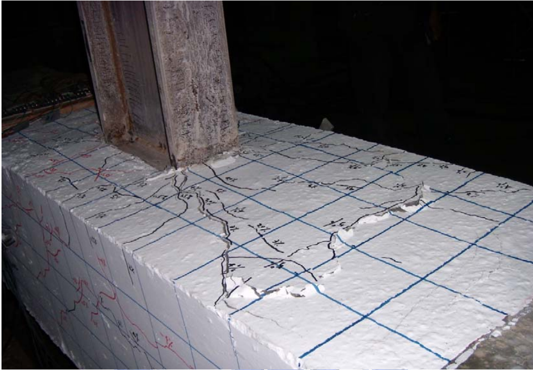
照片 4.5 試體SR0.8-R8 混凝土有明顯開裂隆起 (5% drift)
