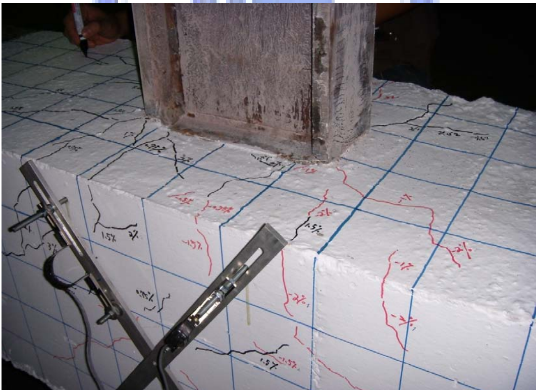
照片 4.2 試體SR0.8-R8 裂縫發展情形 (2% drift)
