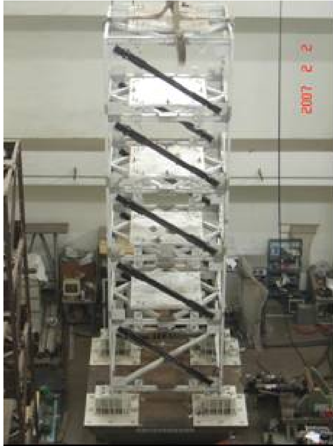
圖 4.10 裝設阻尼器之五層樓模型結構於振動台上
