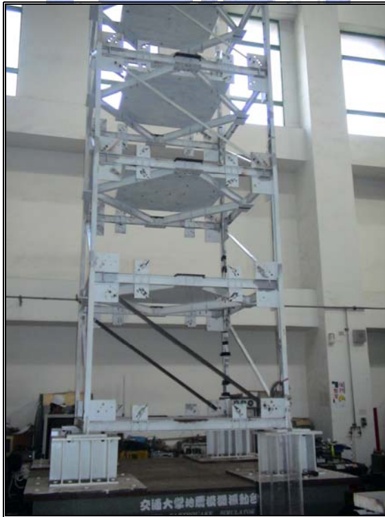
圖 4.7 五層樓鋼構架(移除二樓雙邊斜撐)
