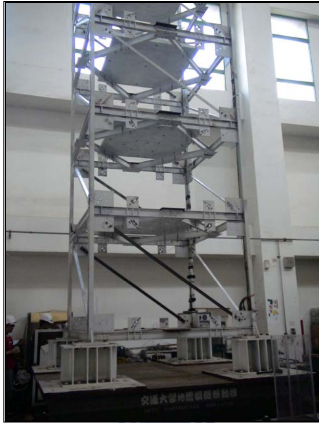
圖 4.14 五層樓鋼構架(移除二樓單邊斜撐)
