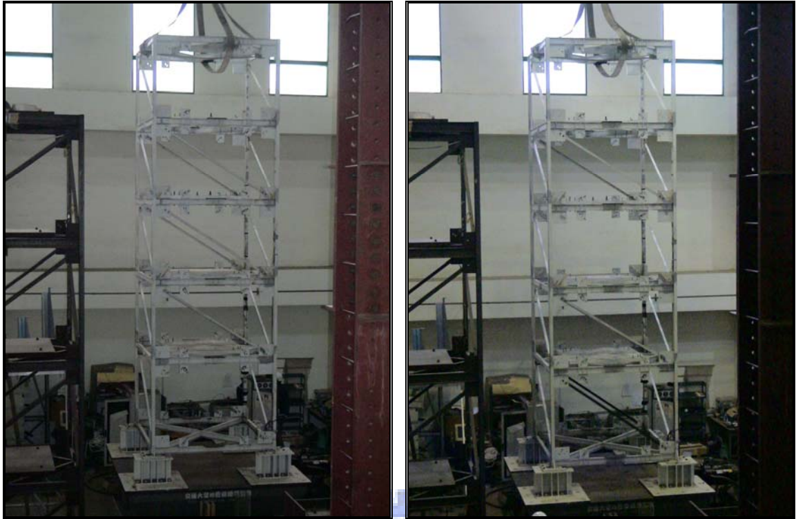
(a) 一、五樓雙邊斜撐移除
