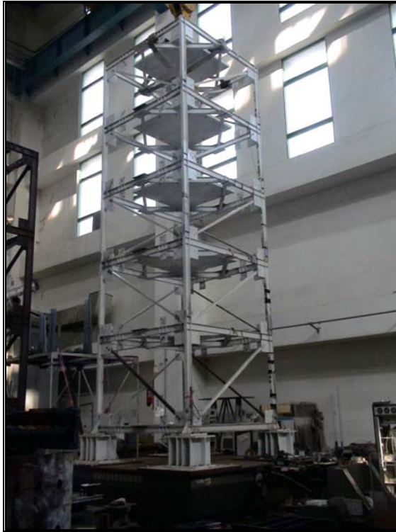
圖 4.6 五層樓鋼構架(未破壞結構)
