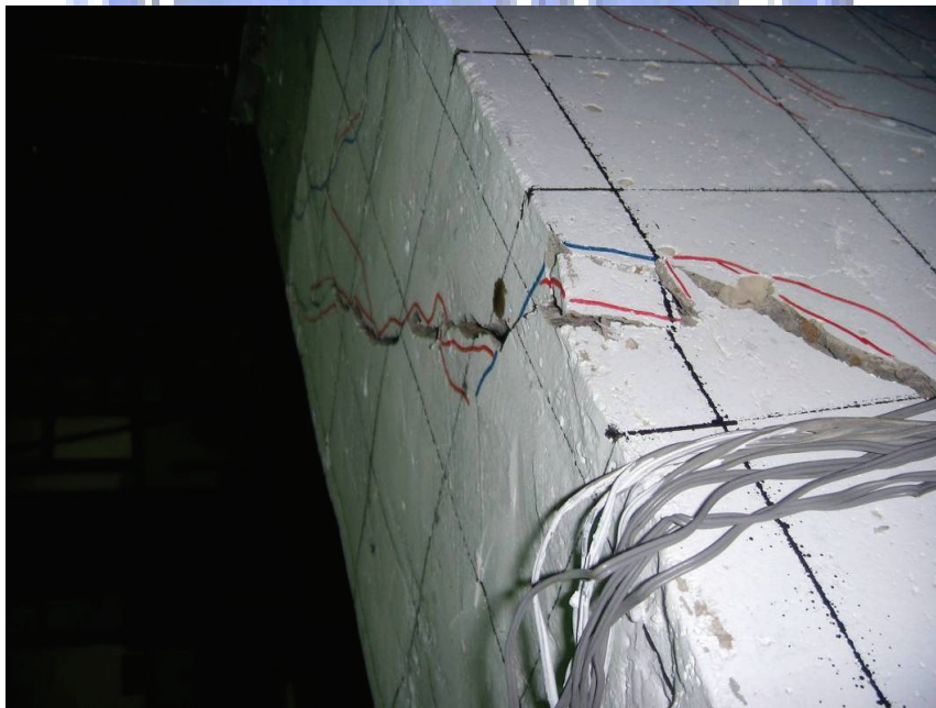
照片 4.5 試體S1-RCγ2 裂縫寬度達 10 mm
