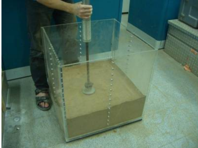
圖 3-6 大型夯錘將土樣分層夯入砂箱（姚奕全，2007）
