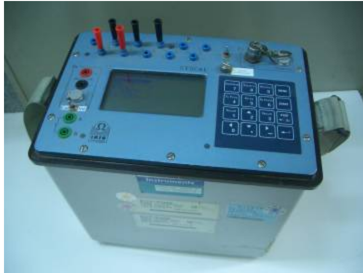
圖 3- 8 地電阻探測儀-SYSCAL PRO Switch 48
