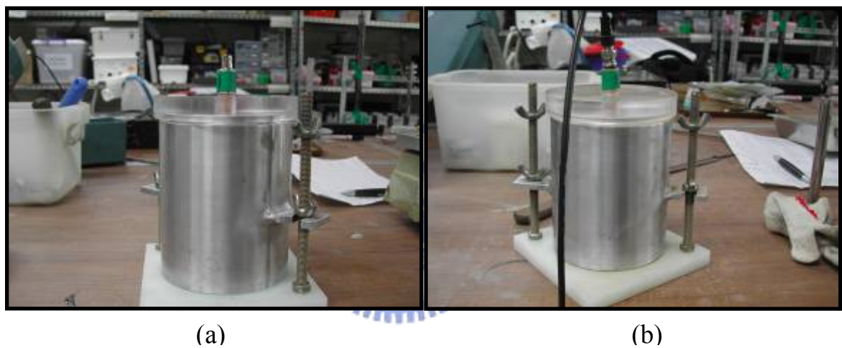
圖 3-4 TDR 率定電阻率與體積含水量
