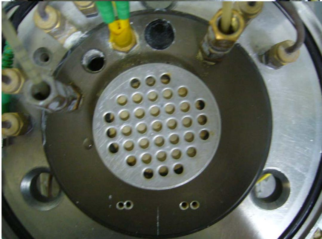
圖 3-16 耐高壓高進氣吸力值陶瓷板
