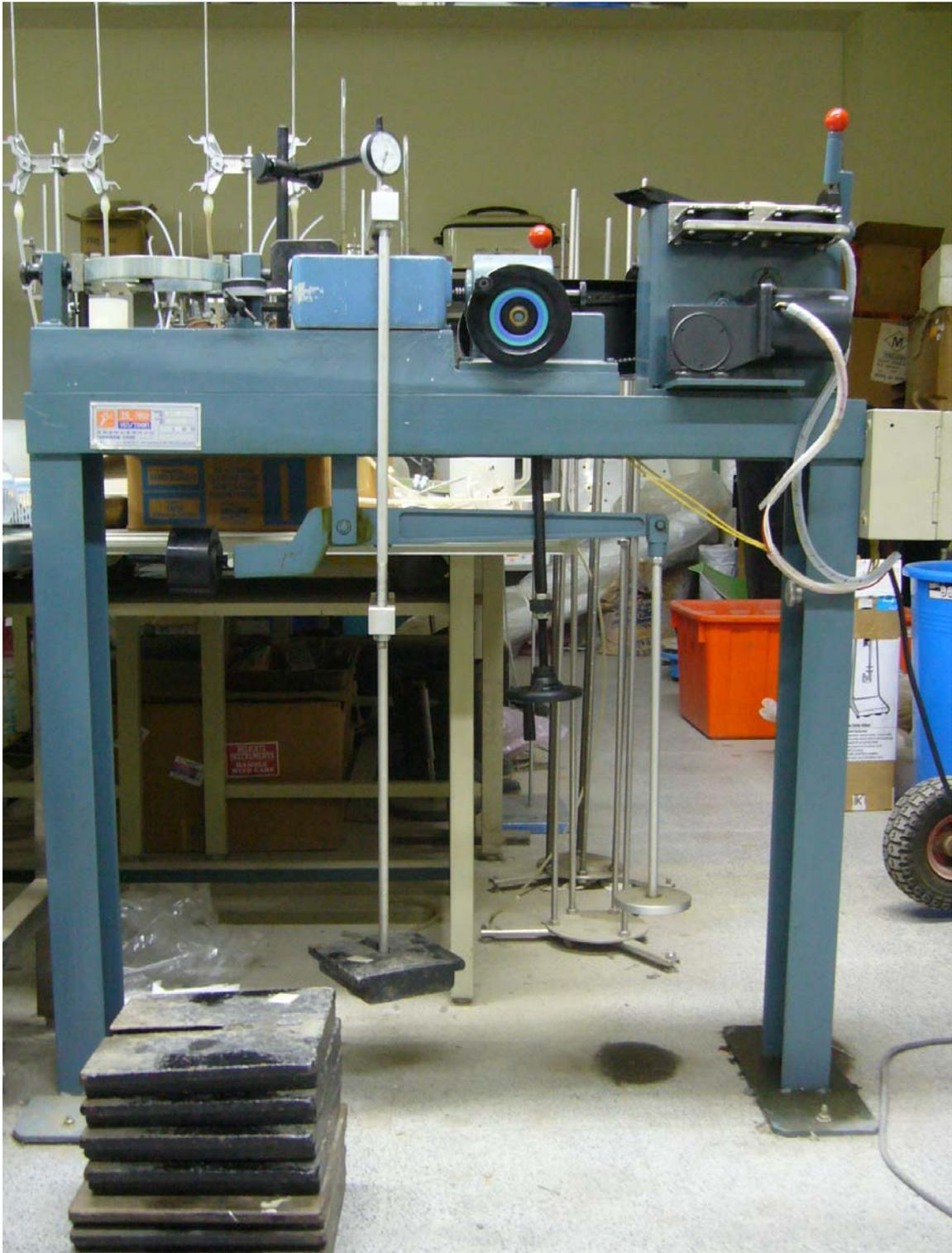
圖 4-17 光纖光柵荷重元標定-土壤直剪試驗儀加載系統
