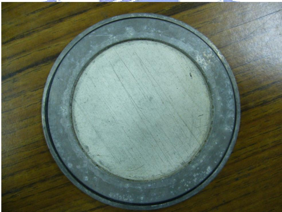
圖 3-14 高進氣吸力值陶瓷板安裝圖
