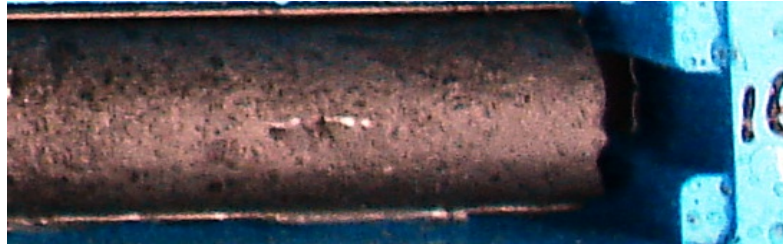
圖 2-9 第一類：灰色黏土夾灰色板岩顆粒（賴忠良，2006）
