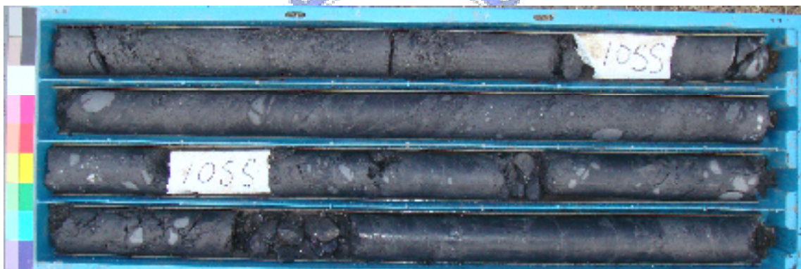
圖 3- 10 鑽取岩心圖漸變帶內之併構崩積土 B-1 孔 12~16m
