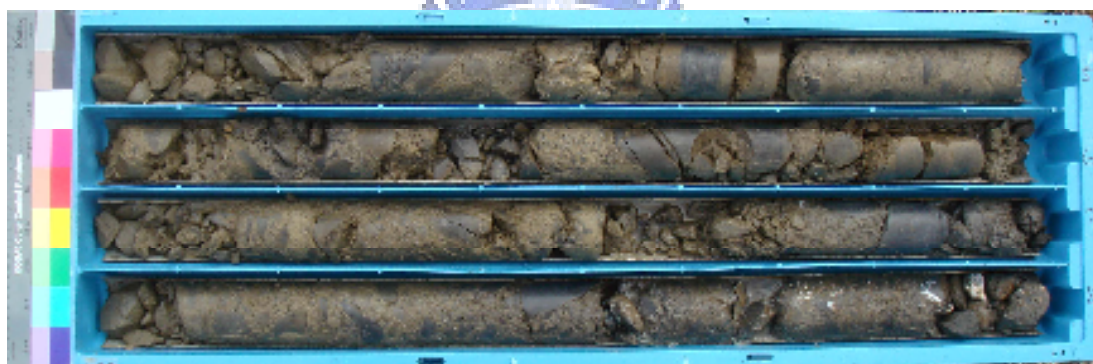
圖 3-7 鑽取岩心圖崩積土內之併構崩積土 B-1 孔 4m
