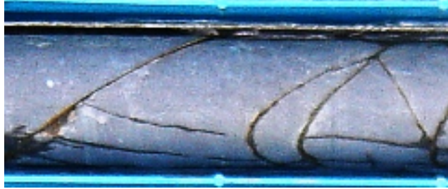
圖 2-11 第三類：灰色板岩內含有節理(節理厚度不可忽略)（賴忠良，2006）
