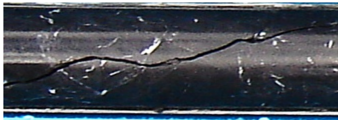
圖 2-12 第四類：灰色板岩內含有節理(節理厚度可忽略)（賴忠良，2006）
