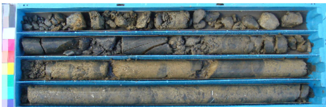
圖 3-8 鑽取岩心圖崩積土內之併構崩積土 B-1 孔 4~8m
