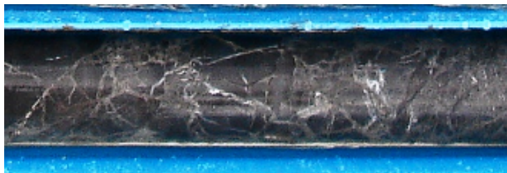
圖 2-10 第二類：破碎板岩岩體（賴忠良，2006）
