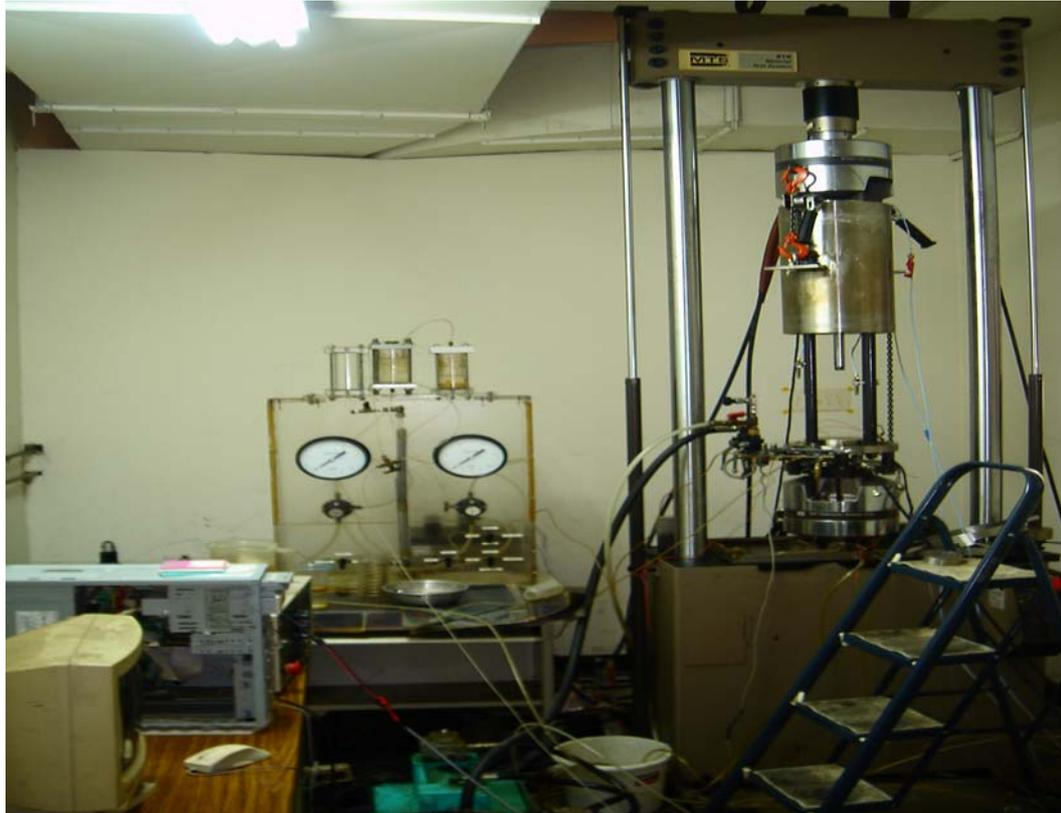
圖 3-16 軟岩三軸試驗系統全景
