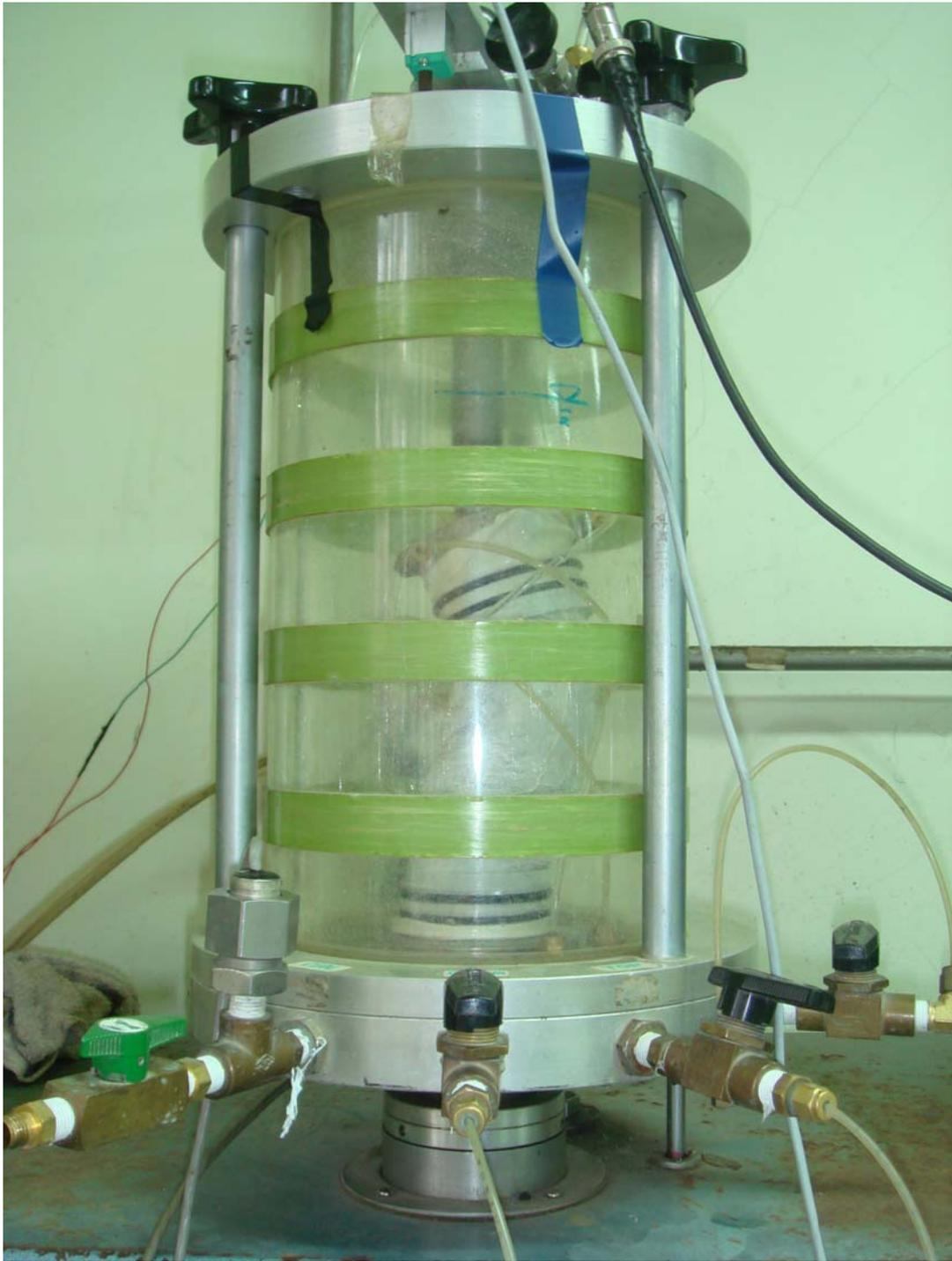
圖 4-3 試驗後試體歪斜情況(以 C-B105 為例)
