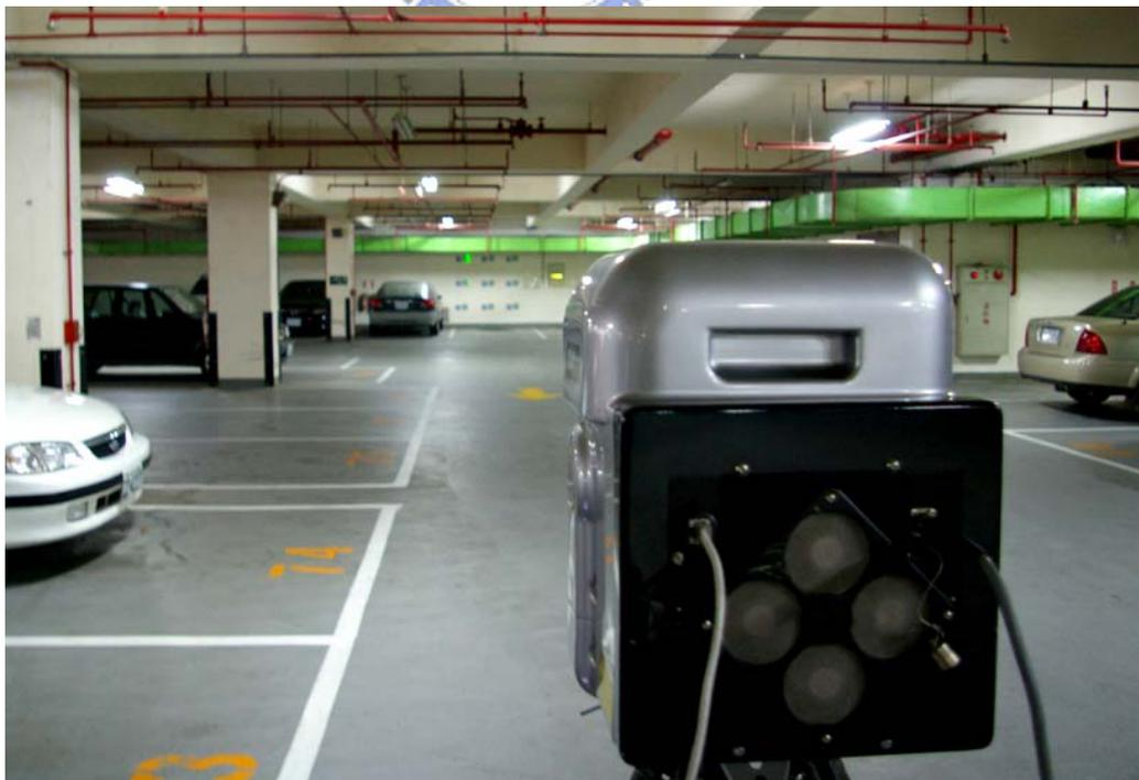
圖 3-6、30m 處架設三維雷射掃瞄儀掃描情形
