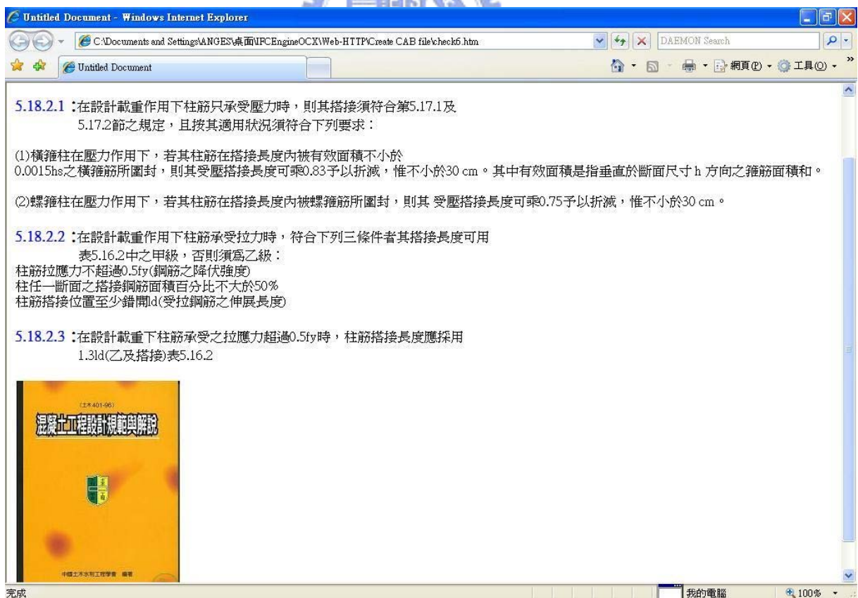
圖 5-4-22 跳出新視窗，柱筋搭接之規範
