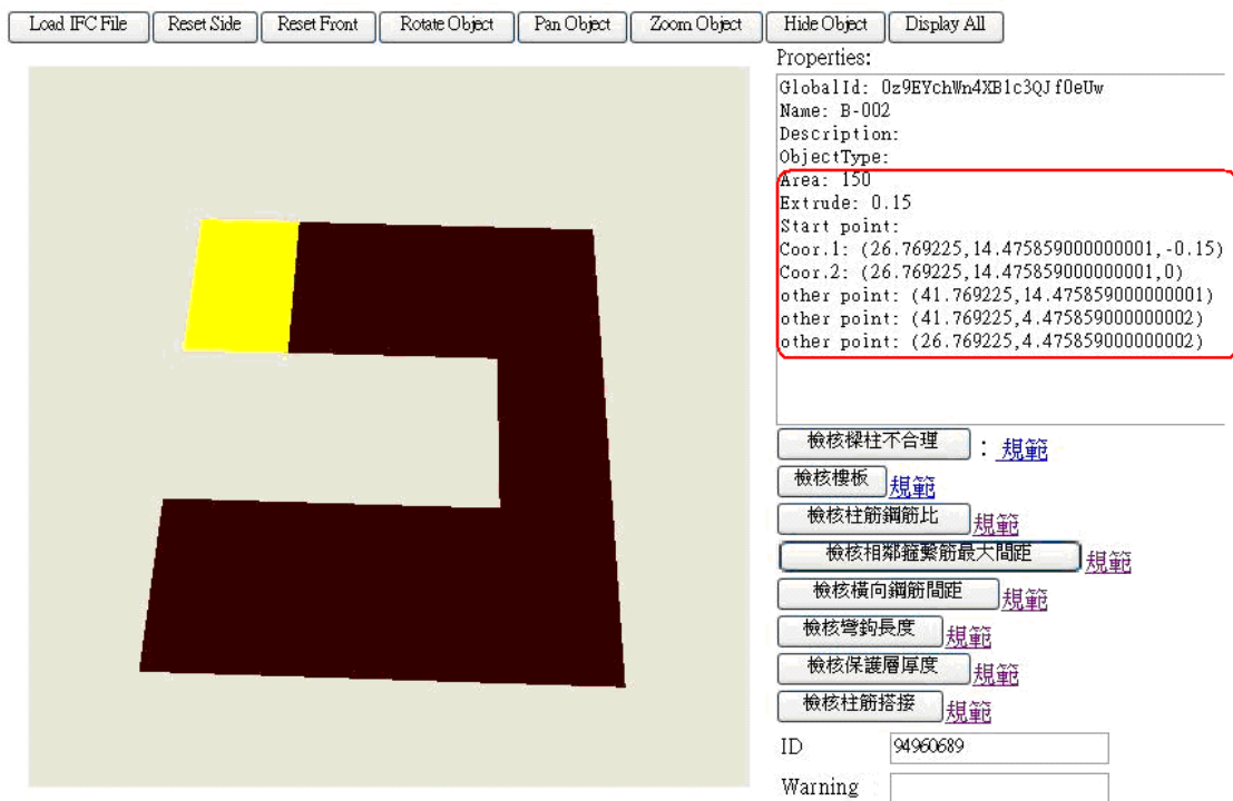
圖 4-4-4 新增功能-抽取樓板面積、樓板厚度及樓板四個角點的座標
