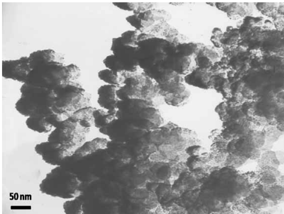
圖 4-10: 鉑系多元觸媒 4p 5min 經過去合金處理後之 TEM 結果，分別為 (a) 4p5min-de0~0.3V(vs Ag/AgCl)、(b) 4p5min-de0~0.5V(vs Ag/AgCl) 和 (c) 4p5min-de0~0.7V(vs Ag/AgCl)。
