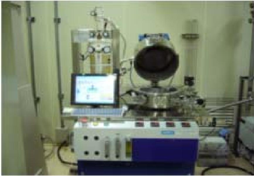
圖 3-3 電漿輔助原子層沉積系統
