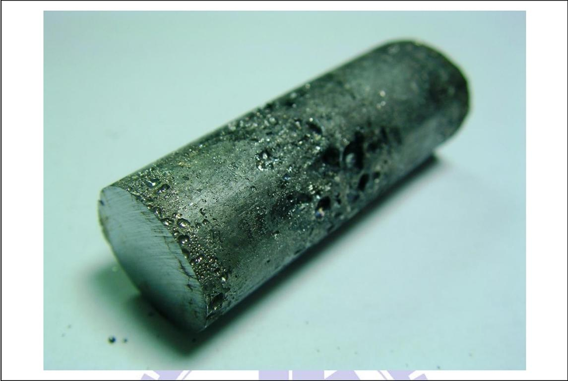
圖 4-26. Bi<sub>0.5</sub>Sb<sub>1.5</sub>Te<sub>3</sub>塊材
