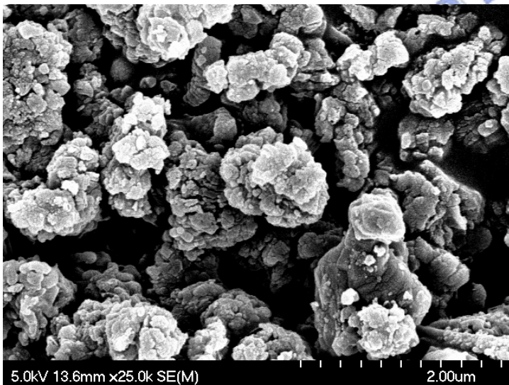
(a) CaAl(95) (b) CaO 圖 4-36 (a)CaAl(95)-O、(b)CaO 經 23 次循環吸脫附測試後之 SEM
