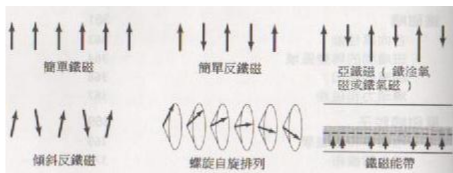
圖 2-4 不同類型的鐵磁自旋排列狀態
