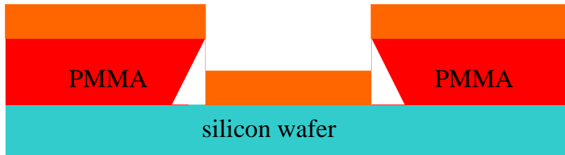
圖 3-4 鍍上材料後的樣品示意圖。
