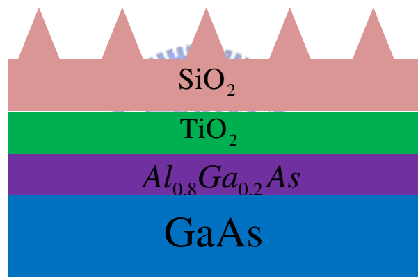
Fig3-1 兩層均質抗反射層加上一維光柵的設計。
