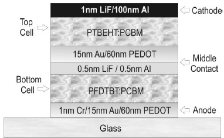
圖 2-3 Blom 團隊所發表的全溶液製程的疊層式太陽能電池的元件結構圖[30]
