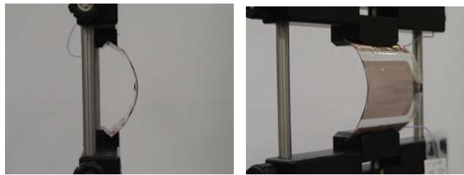
圖 5-3 測量曲率半徑的裝置
