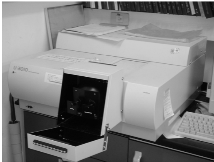
圖十一：日本 Hitachi 公司所製紫外-可見光光譜儀配備積分球
