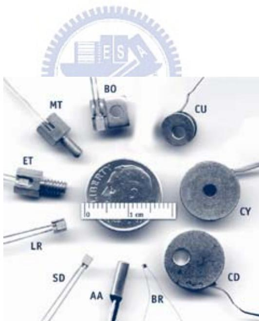
圖 3-16a 不同樣式的 Cernox 溫度計。我們所使用的兩顆 Cernox 溫度計是 CU 的包裝樣式，編號皆是 CX-1050-CU-1.4L，CX-1050 是型號，1.4L 代表適用範圍(室溫至 1.4 K)。
