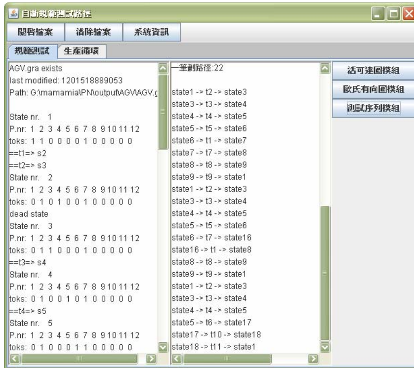
圖 5.7 自動導引車輛範例之規範測試路徑產生
