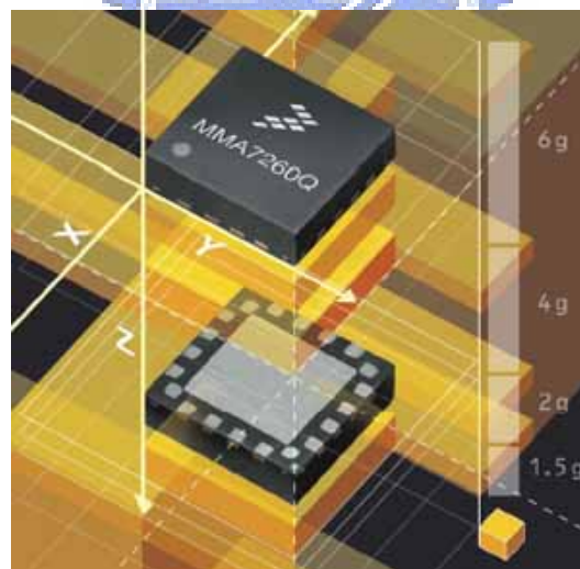
圖 4.11：Freescale 的動作感測元件
