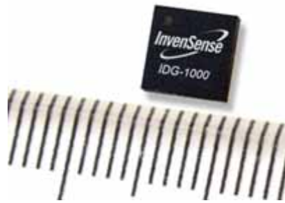
圖 4.12：InvenSense 的動作感測元件
