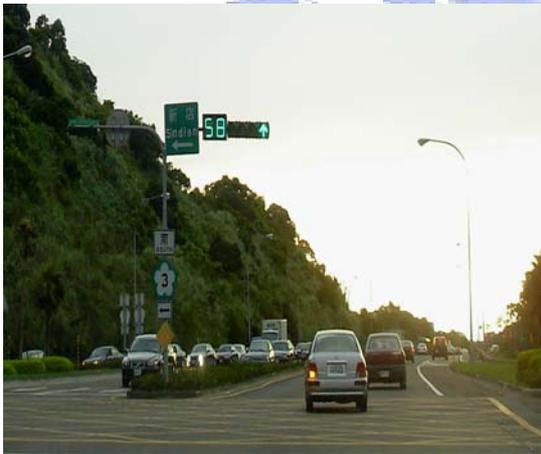
圖 1.4 外掛式車行綠燈倒數計秒器
