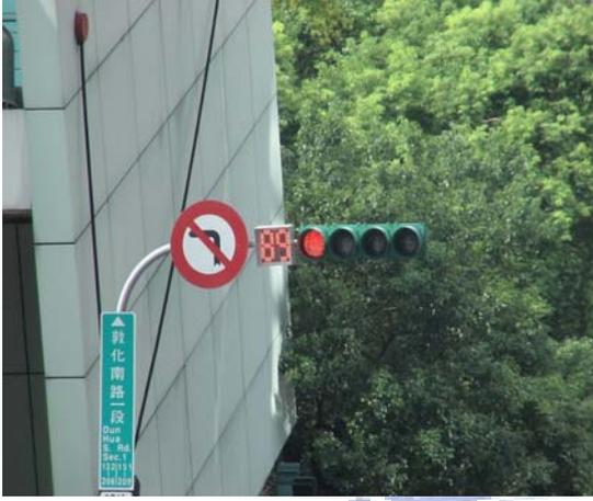
圖 1.2 外掛式車行紅燈倒數計秒器
