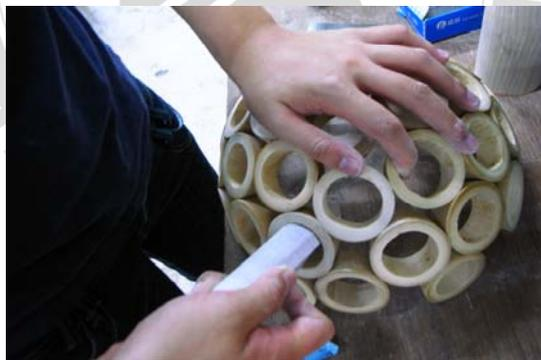
圖六十四、以捲起的砂紙打磨竹管內部
