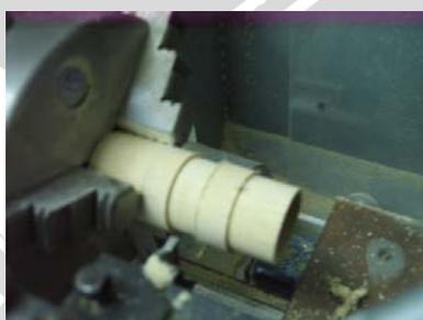
圖三十八、竹管斷差車製圖
