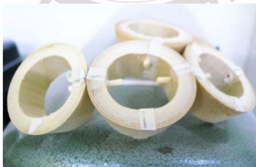
圖五十四、增加結構力度的斜角與竹釘
