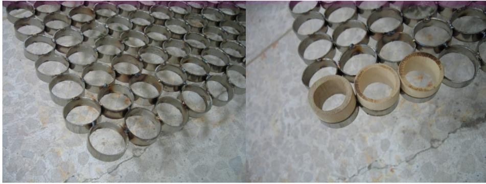
圖四十六、竹管套入鐵管後之前、後效果圖
