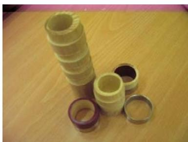
圖三十九、車製完斷差的竹管
