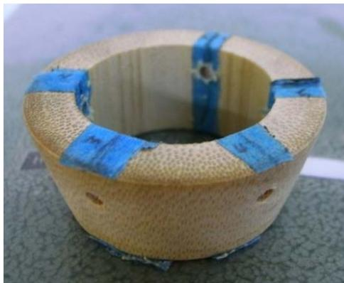
圖五十七、斜車的「梯形」元素，經過角度對位後鑽孔
