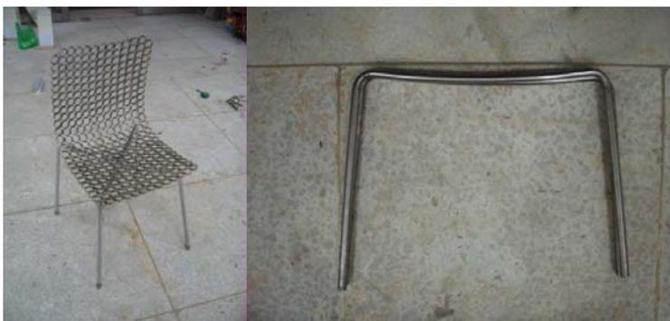
圖四十八、改變椅腳高度，讓椅面依照身體坐姿角度傾斜
