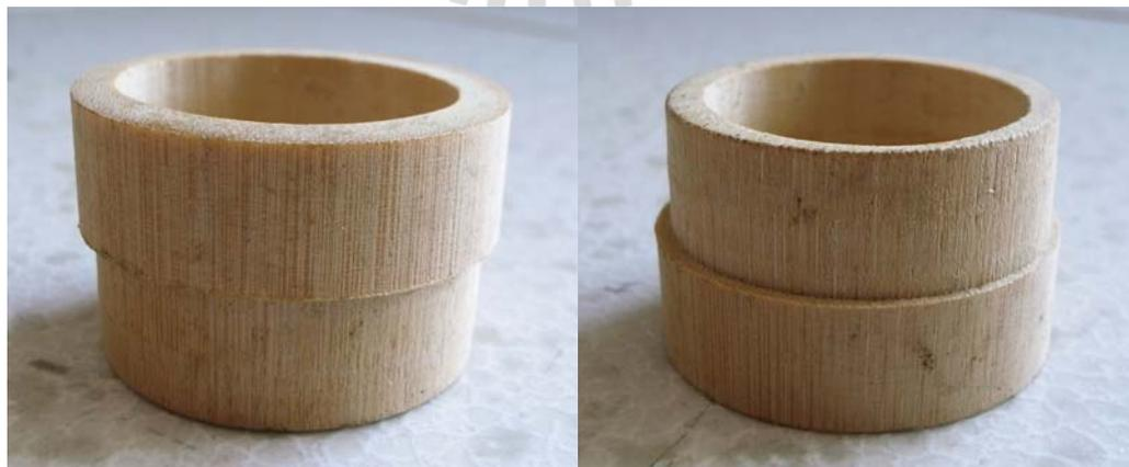
圖二十八、「O」型竹管上車部分斷差，側面形成「T」型元素；
