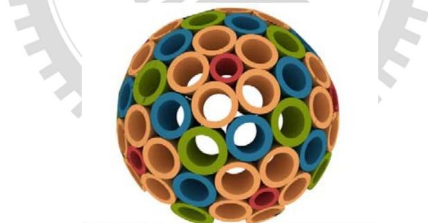
圖五十六、3D 模擬，四種尺寸的竹管可形成一穩固圓球體
