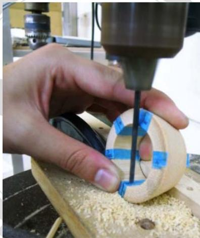
圖五十九、製做靠板，使斜車的竹管可順利鑽孔
