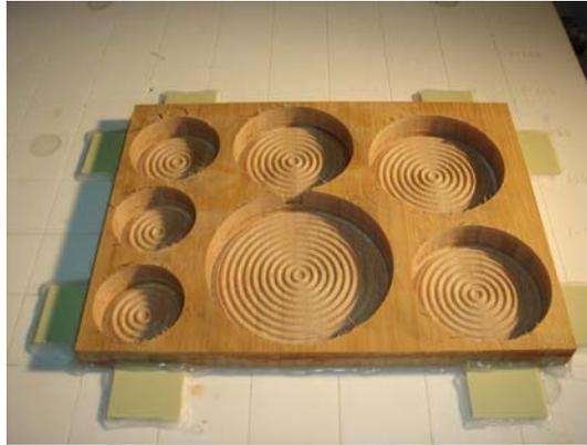
圖六十三、竹杯隔板的加工圖
