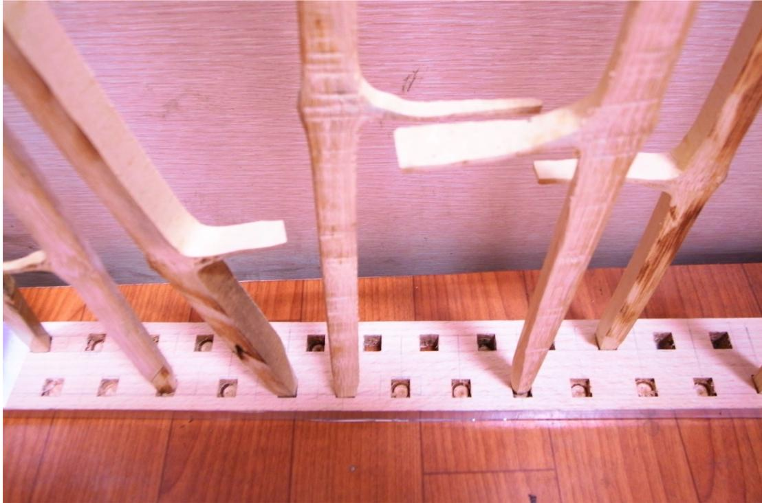
圖七十四、雙層的竹條設計。使竹條有前後不同的層次感，並減少兩根細竹條之間的縫隙
