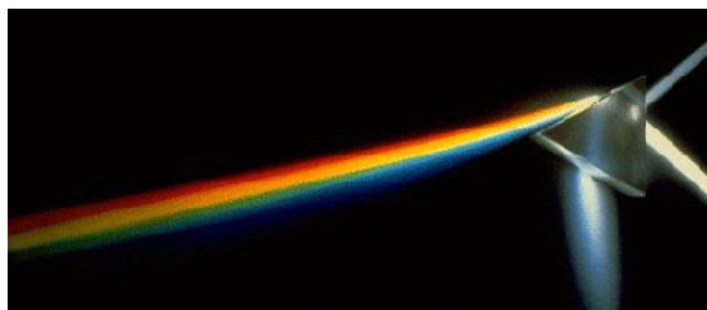
圖 2.1 三稜鏡將分解為七彩的光線
