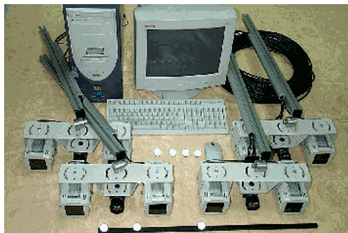
圖 3.1.8 3D 反光球及紅外線感測器 (Wu, 2004)
