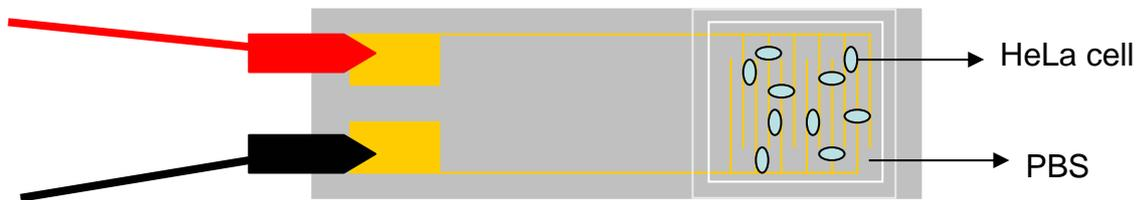
圖 2-3-2 電刺激方式示意圖。
