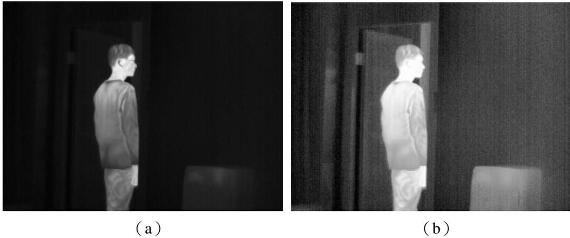
圖 2-1 紅外線影像轉換灰階圖，(a)一般紅外線轉換灰階方法，(b)紅外線影像對比強化方法。
