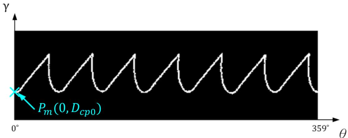
圖 3.15 銑刀魚尾端面輪廓點剖視圖
