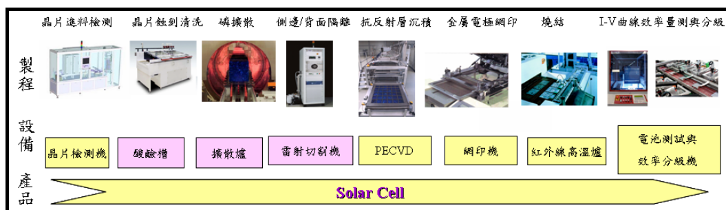
圖 14 電池段主要製程與設備
