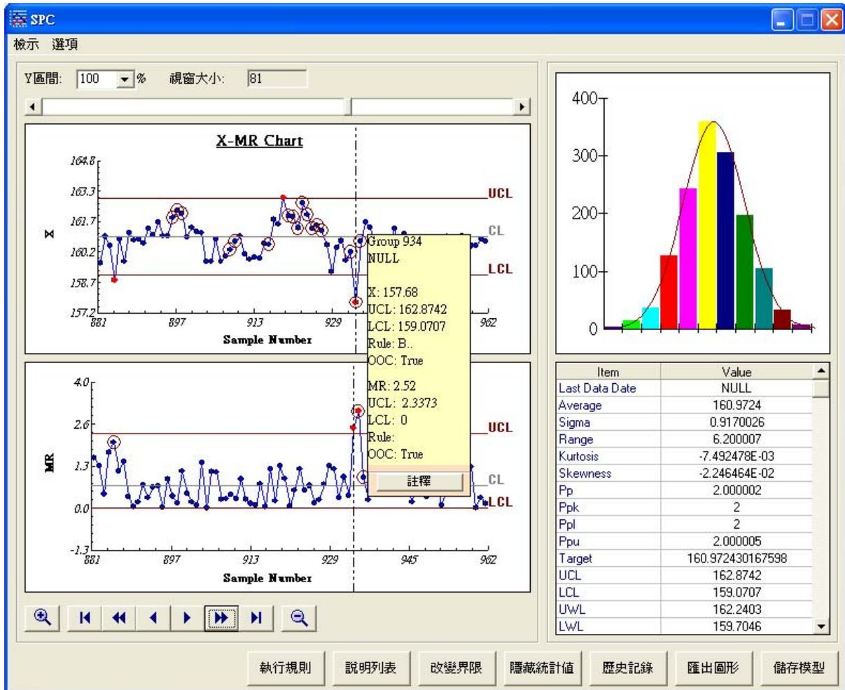
圖 16 SPC 管制圖檢測第 934 點壓降情形
