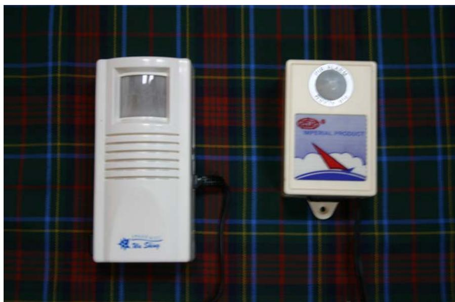
圖 2-11 移動式紅外線感測器
